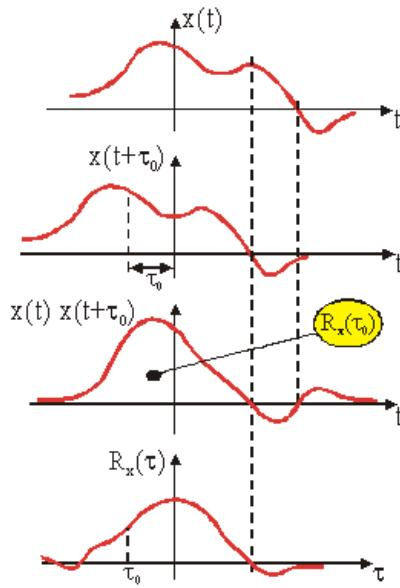
Slika 3.1. Ilustracija proračuna autokorelacije za kontinuirani signal (preuzeto iz FSB (2021) [http://lab425.fesb.hr/TINF/teorijainf\\_8.htm](http://lab425.fesb.hr/TINF/teorijainf_8.htm))
