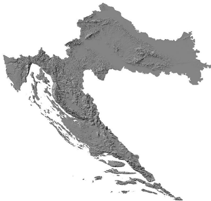
Slika 5-7. Digitalni model reljefa nakon obrade naredbom Hillshade .
