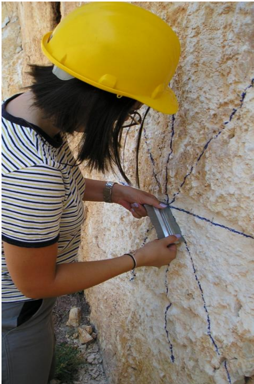
Slika 5-8 Mjerenje profila hrapavosti profilometrom.
