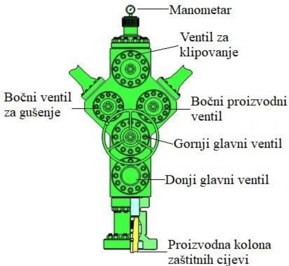
Slika 2-3. Monolitni erupcijski uređaj (pet-oil.blogspot.com, 2020)
