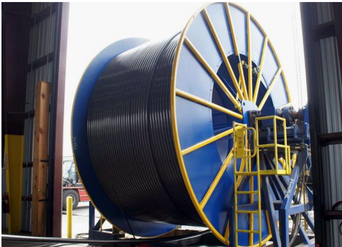
Slika 2-5. Savitljivi tubing (www.octgproducts.com, 2020)
