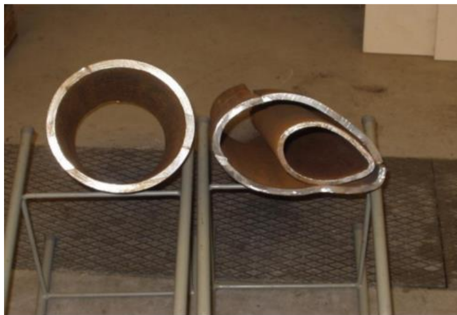
Slika 4-2. Oštećeni segment proizvodne kolone zaštitnih cijevi s tubingom (WIF, NTNU & UiS, 2012).
