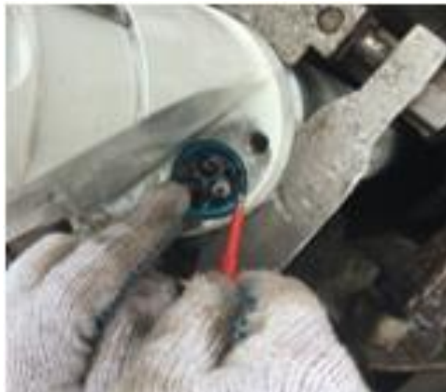
Slika 4-8. Zamjena transportnih s radnim brtvama (INA d.d., 2019)
