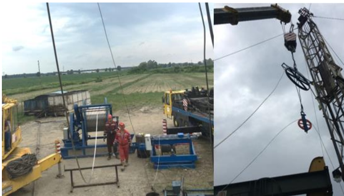
Slika 4-3. Prikaz koloture i motalice za kabel i vod za ubrizgavanje (INA d.d., 2019)
