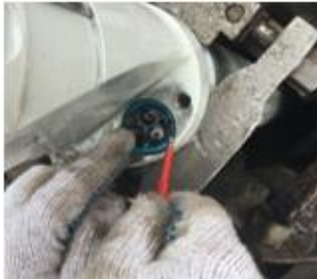
Slika 4-8. Zamjena transportnih s radnim brtvama (INA d.d., 2019)
