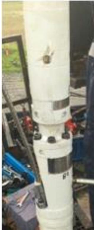
Slika 4-11. Spajanje protektor sekcije i skidanje čepova (INA d.d., 2019)
