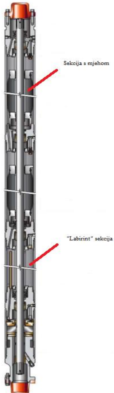
Slika 2-8. Sekcija s mjehom i pregradama (Merrill i Dwiggins, 2017)
