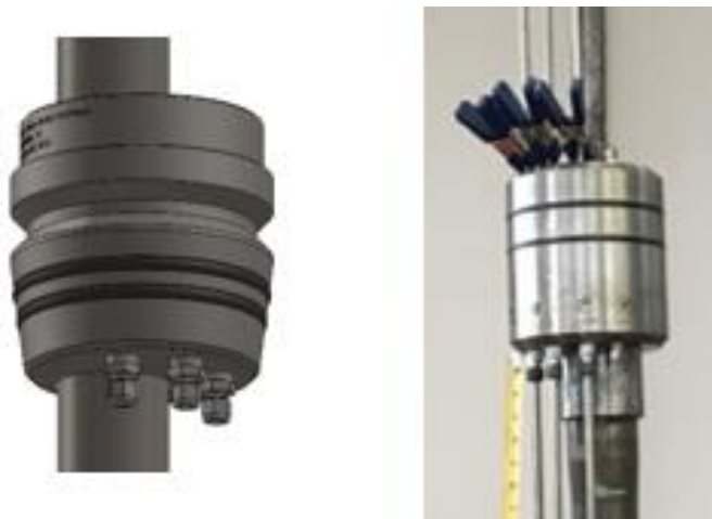
Slika 4-17. Tubing vješalice i žile penetratora (INA d.d., 2019)
