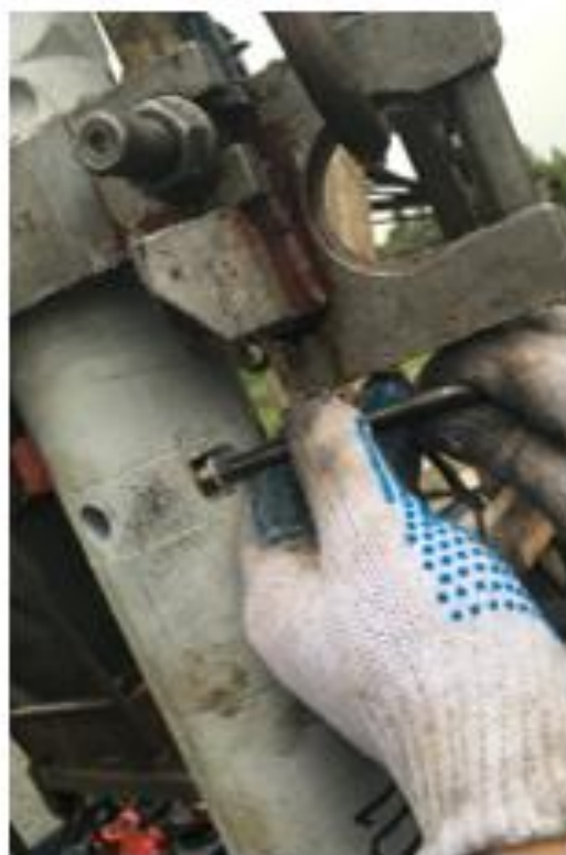
Slika 4-11. Spajanje protektor sekcije i skidanje čepova (INA d.d., 2019)
