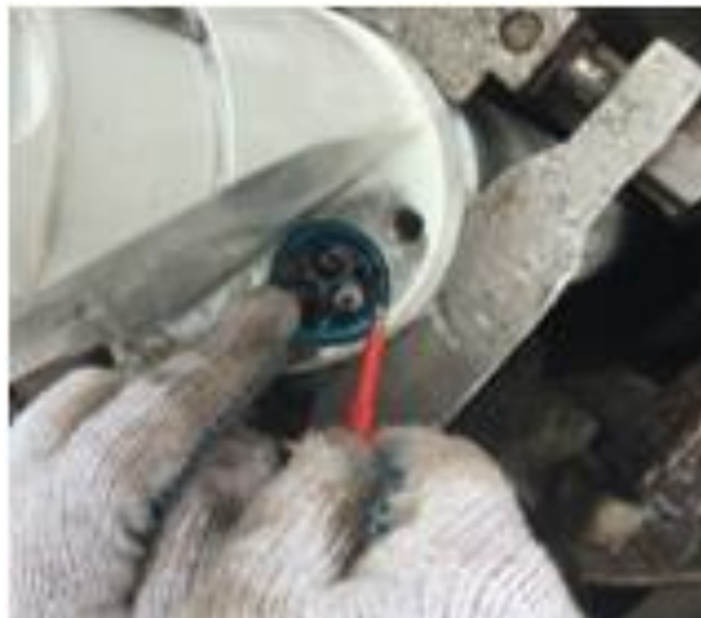
Slika 4-8. Zamjena transportnih s radnim brtvama (INA d.d., 2019)
