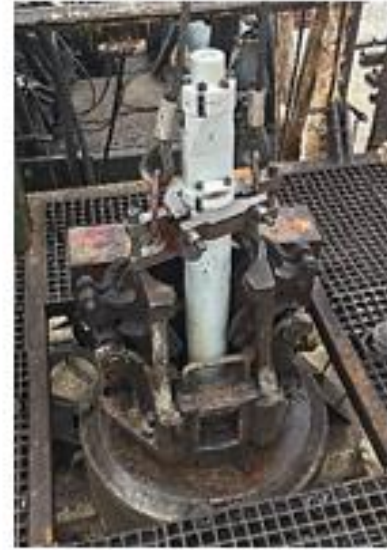
Slika 4-4. Zadizanje i odsjedanje sekcije motora i telemetrijske jedinice (INA d.d., 2019)
