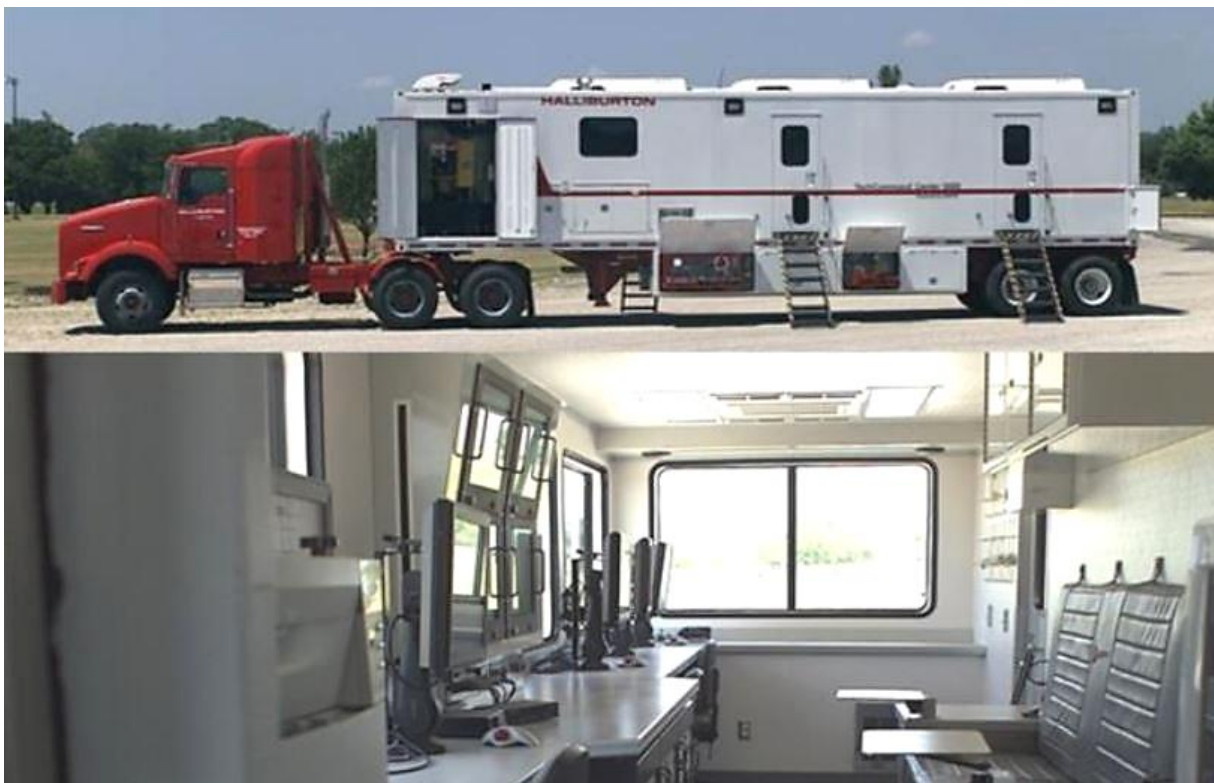
Slika 5-3. Vozilo za nadzor podataka (Pongratz, 2019)
