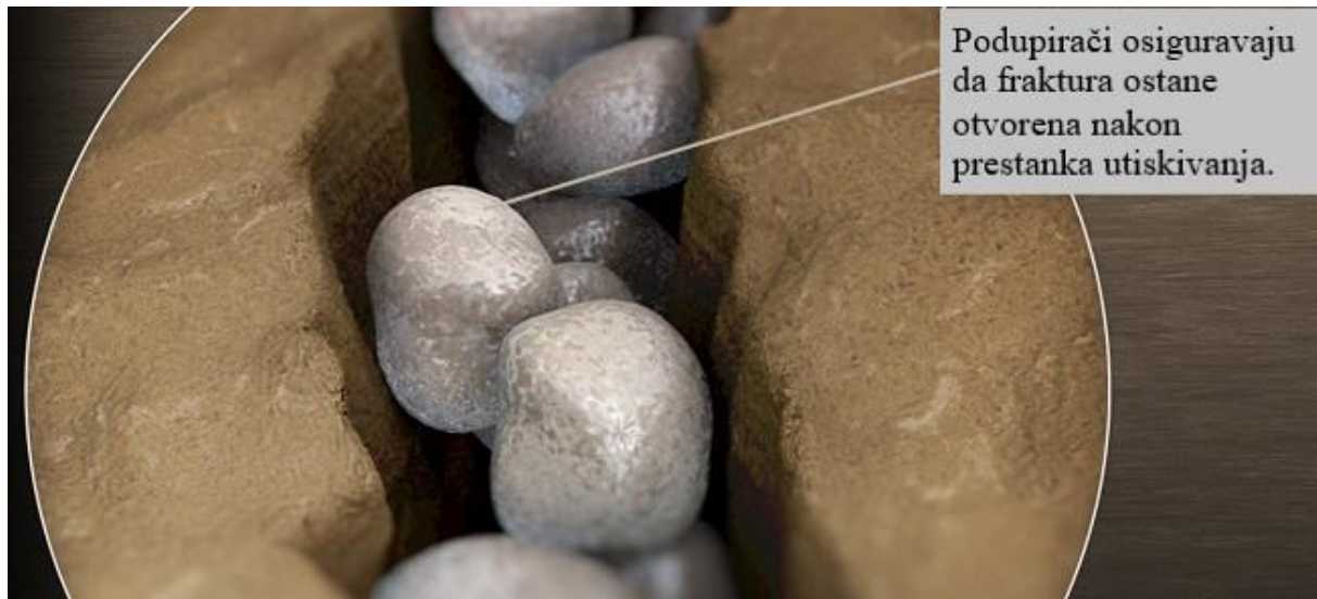
Slika 4-1. Shematski prikaz podupirača u stvorenoj pukotini (www.jasonmunster.com, 2020)
