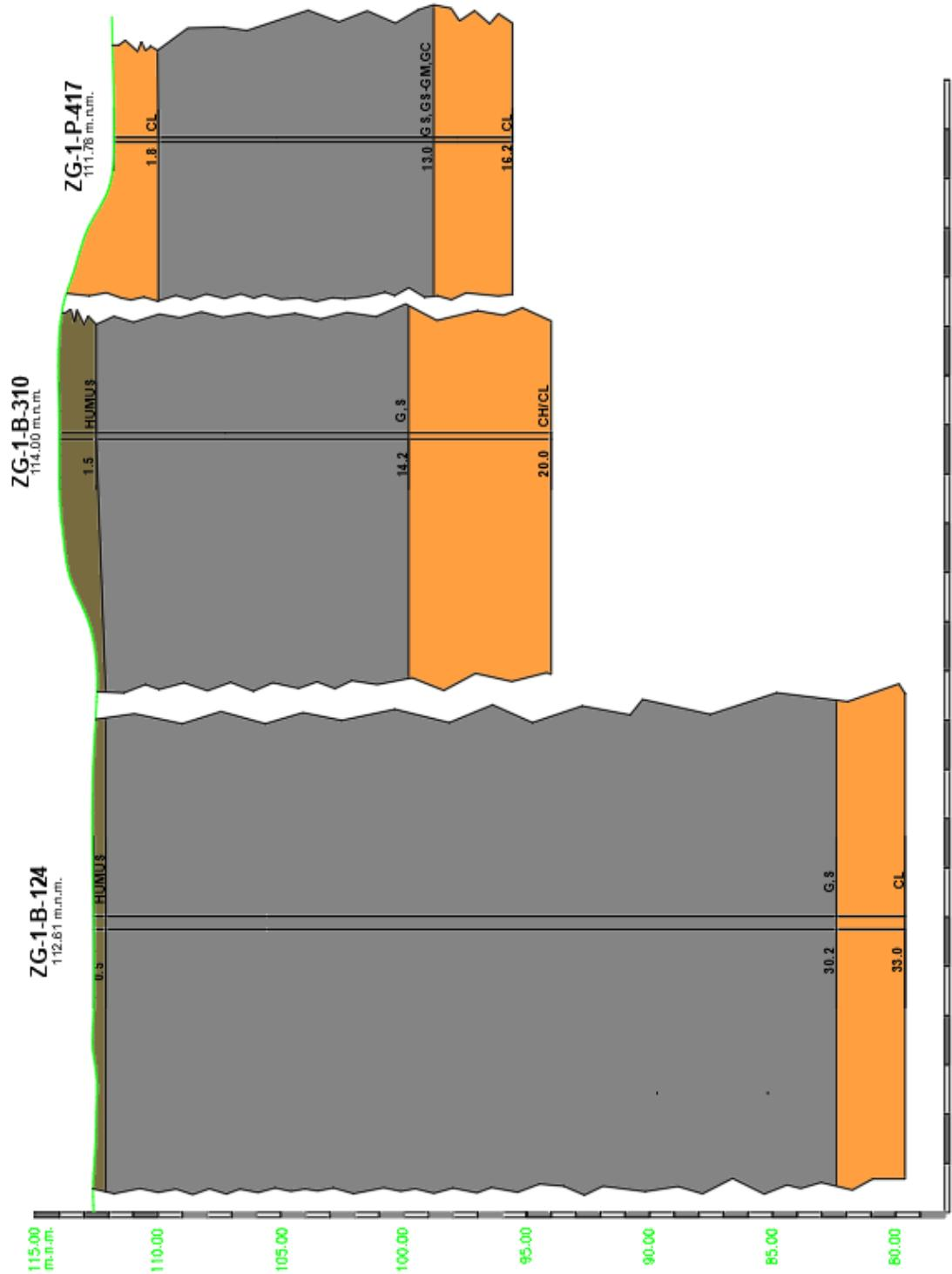
Slika 4-7. Prognozni geotehnički profil A-A' (2)
