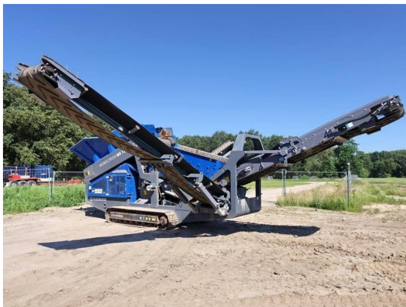
Slika 4-11 Pokretno vibracijsko sito Kleemann MS 12Z (Kleemann, n.d.)
