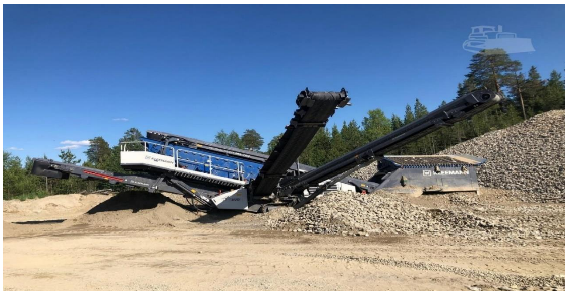
Slika 4-12 Separacijsko postrojenje Kleemann Mobiscreen MS 703 EVO (Kleemann, nd.)
