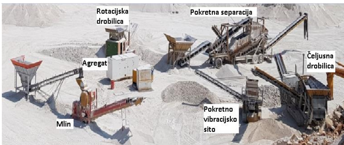
Slika 4-2 Postojeći razmještaj mobilnog oplemenjivačkog postrojenja
