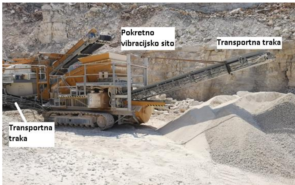
Slika 3-3 Pokretno vibracijsko sito Pezzoli
