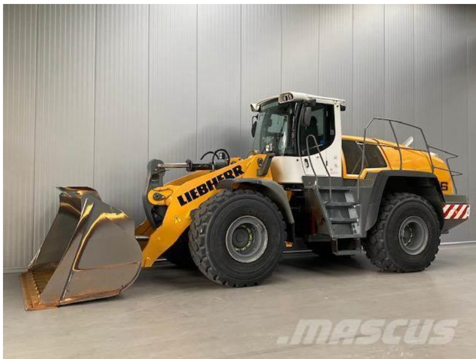
Slika 4-14 Utovarivač Liebherr 576 (Liebherr, n.d.)
