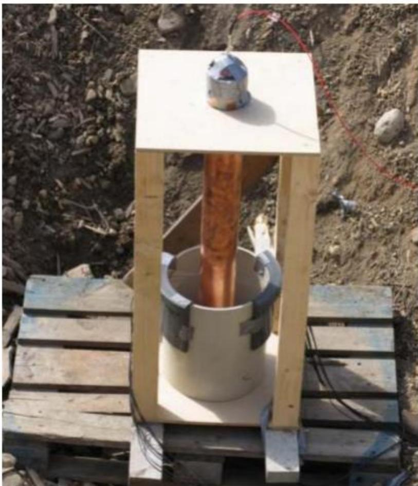
Slika 6-3: Test ekspanzije cilindra (Esen i suradnici, 2005)
