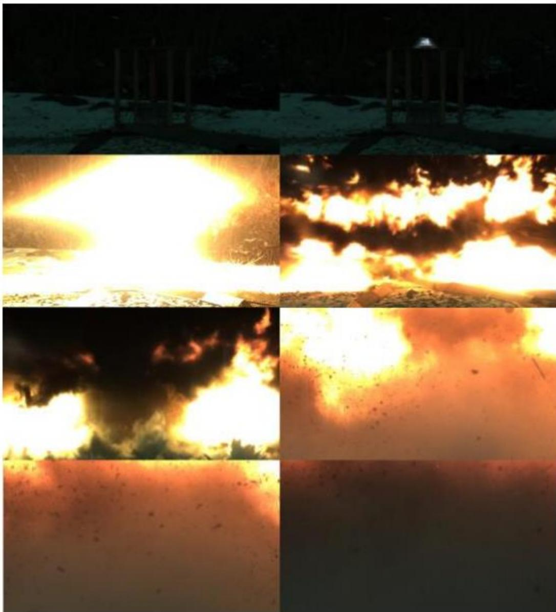
Slika 6-4: Detonacija u ekspanzijskom cilindru snimljena brzom kamerom (Topkaroglu, 2014)
