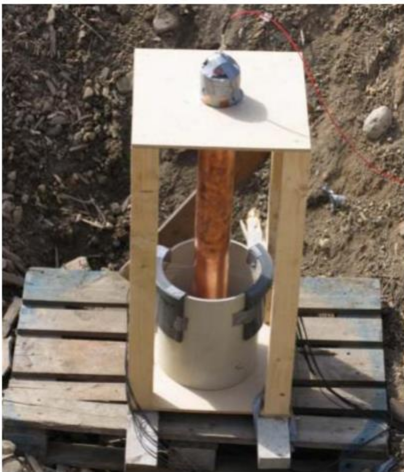
Slika 6-3: Test ekspanzije cilindra (Esen i suradnici, 2005)
