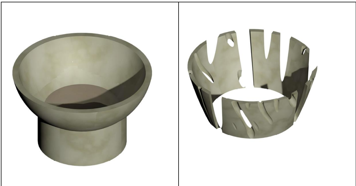
Slika 7-2: Cilindar tijekom ispitivanja (Dobrilović, 2021)
