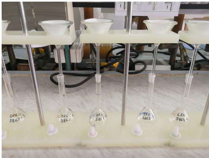
Slika 4.7. Filtriranje uzoraka tijekom CEC
