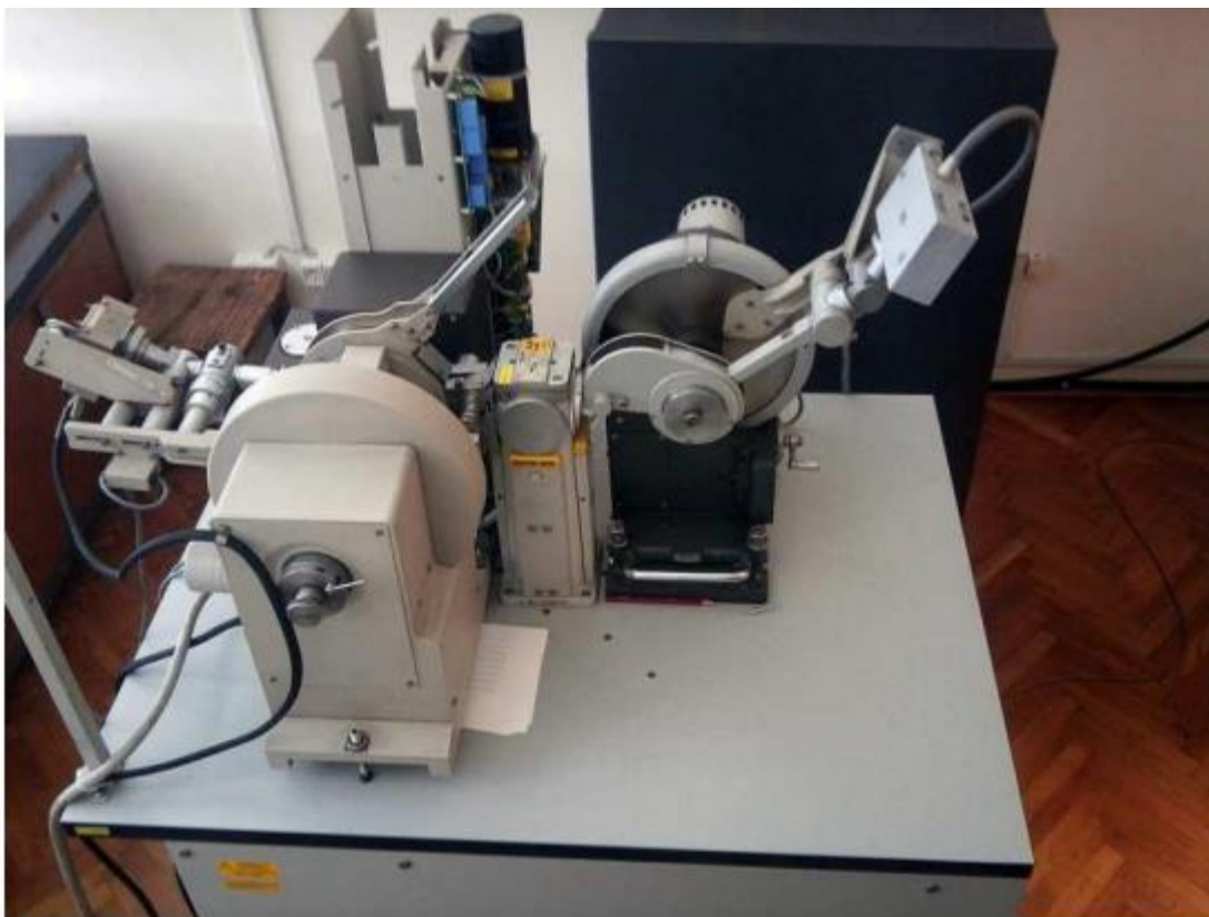
Slika 4.13. Rendgenski difraktometar s brojačem „Phillips PW 1830“ (foto: Lucija Mihaljević)
