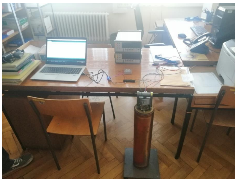
Slika 3-2. Postav umjeravanja grijaćeg tijela
