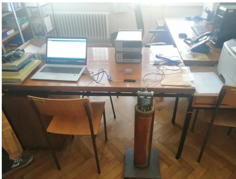
Slika 3-2. Postav umjeravanja grijaćeg tijela
