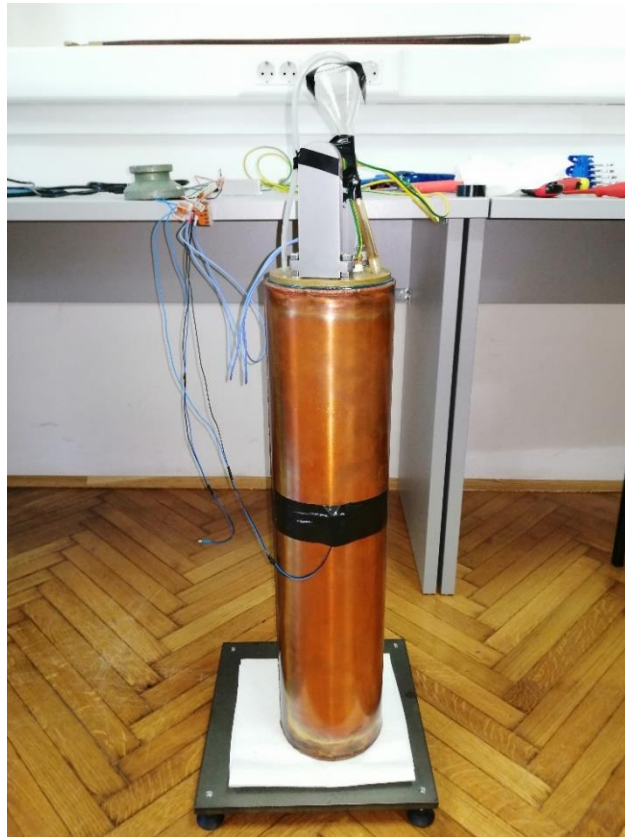
Slika 3-4. Saturacija pijeska uljem
