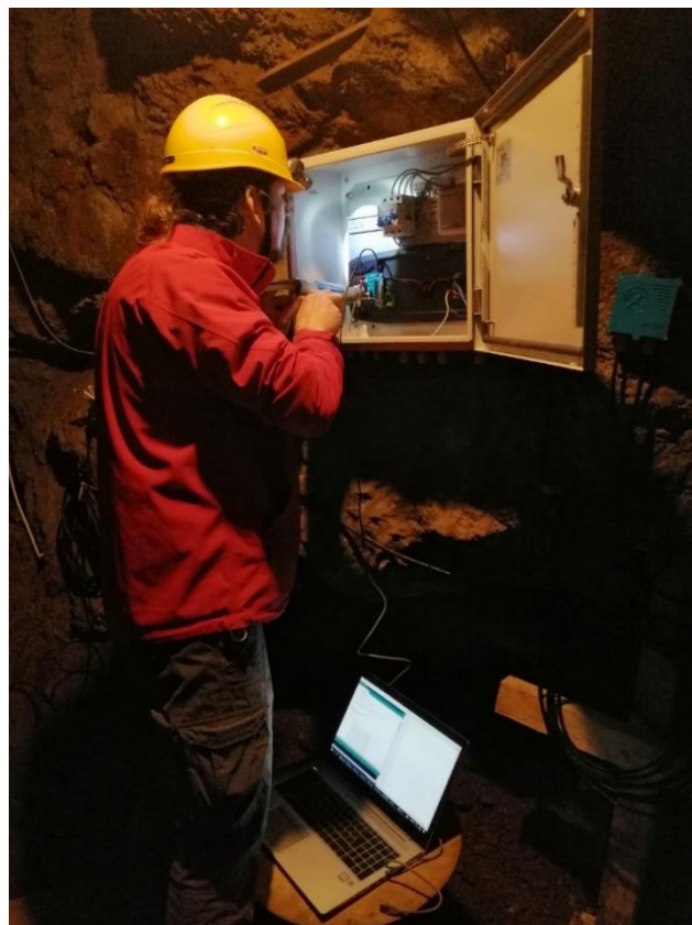
Slika 3-12. Spajanje senzora za mjerenje temperature i vlažnosti
