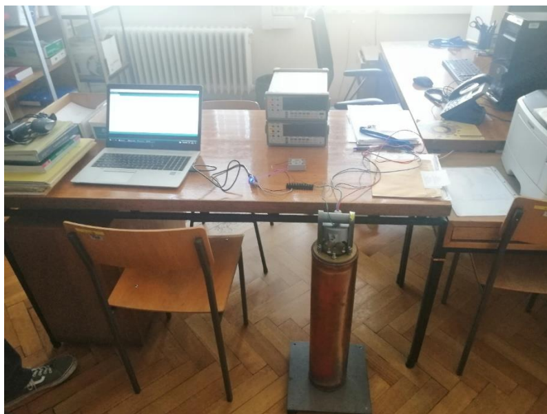
Slika 3-2. Postav umjeravanja grijaćeg tijela
