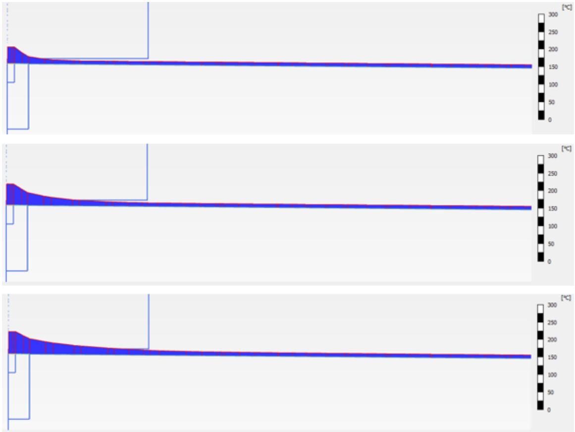
Slika 4-8. Poprečni presjek kretanja temperature prvi, peti i dvadeseti dan grijanja
