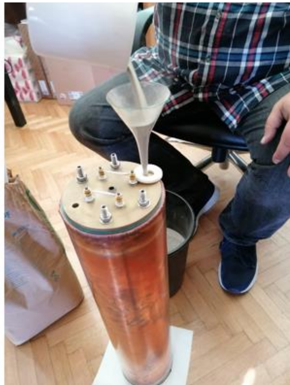
Slika 3-3. a) Ispunjavanje grijaćeg tijela kvarcnim pijeskom b) Dopunjavanje i nivelacija razine kvarcnog pijeska u grijaćem tijelu
