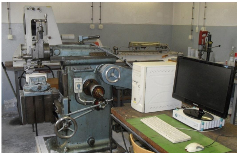
Slika 5. Uređaj za pravolinijsko rezanje stijena (Korman, 2014)
