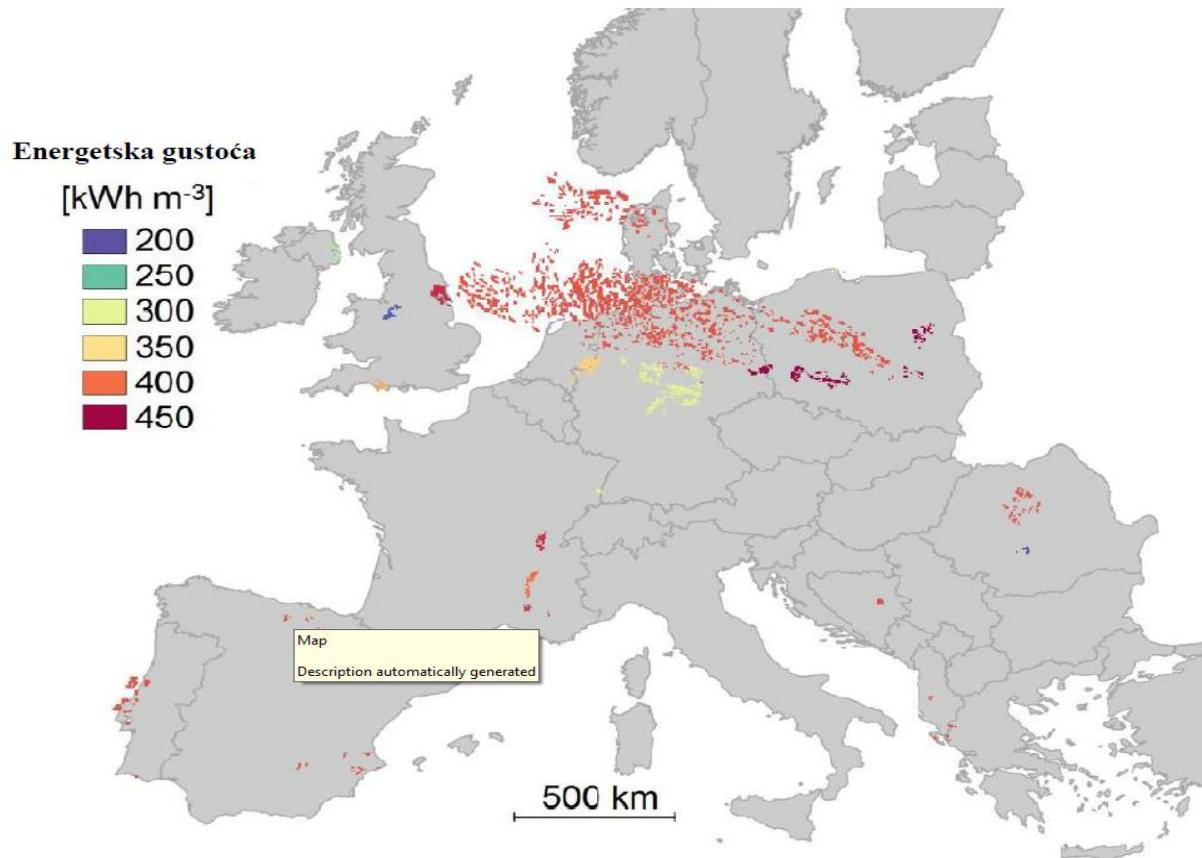
**Slika 5-4.** Raspored potencijalnih solnih kaverni u ovisu o energetskoj „gustoći“ (Caglyan et al, 2020.)
