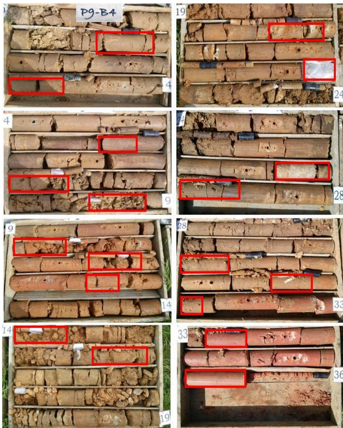
Slika 13 Jezgra bušotine P9– B4 (lokacija Sjeverna ulica), dubine 35 m s oznakama mjesta uzorkovanja za laboratorijska ispitivanja
