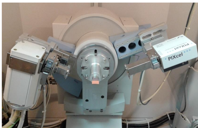
Slika 16 Rendgenski difraktometar u vlasništvu Hrvatskog geološkog instituta s vertikalnim \theta - \theta goniometrom, keramičkom rendgenskom Cu-cijevi, PiXcel-ovim detektorom i odgovarajućim nosačima za uzorke (na slici je vidljiv nosač za orijentirane uzorke). Prilikom snimanja uzorak miruje, dok rendgenska cijev i detektor rotiraju oko uzorka.
