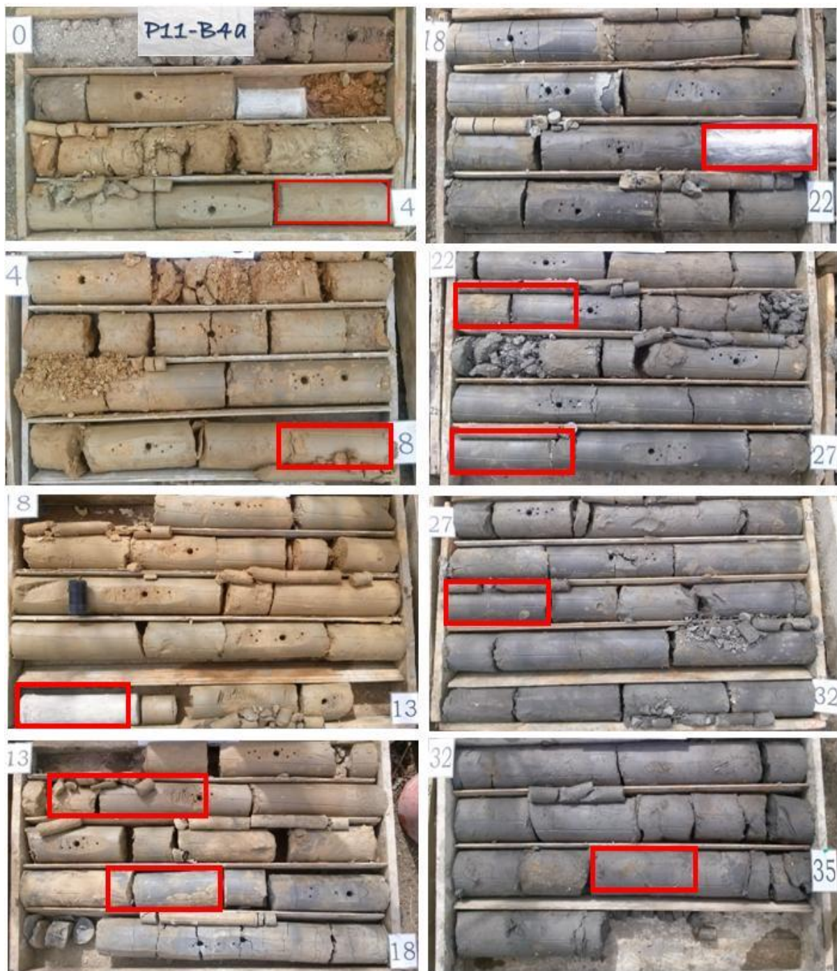
Slika 15 Jezgra bušotine P11– B4a (lokacija u ulici Dobrodolski Breg, dubine 35 m s oznakama mjesta uzorkovanja za laboratorijska ispitivanja)
