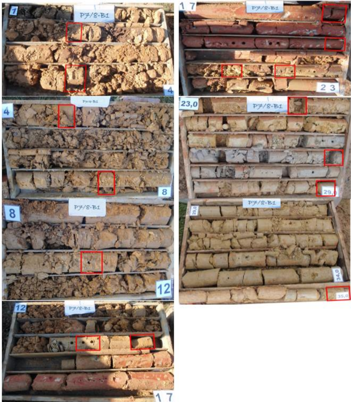
Slika 9 Jezgra bušotine P7/8 – B1 (lokacija Črešnjevce) dubine 35 m s oznakama mjesta uzorkovanja za laboratorijska ispitivanja
