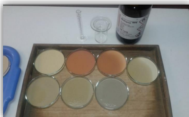
Slika 19 Sušenje uzoraka pomiješanih s ZnO i metanolom nakon usitnjavanja u McCronovom mlinu.
