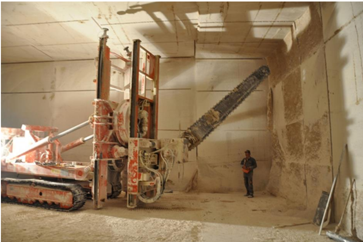
Slika 3-5. Lančana sjekačica u podzemnom radu (preuzeto sa https://www.kamen.hr/hr/kamenolomi/kanfanar/ )
