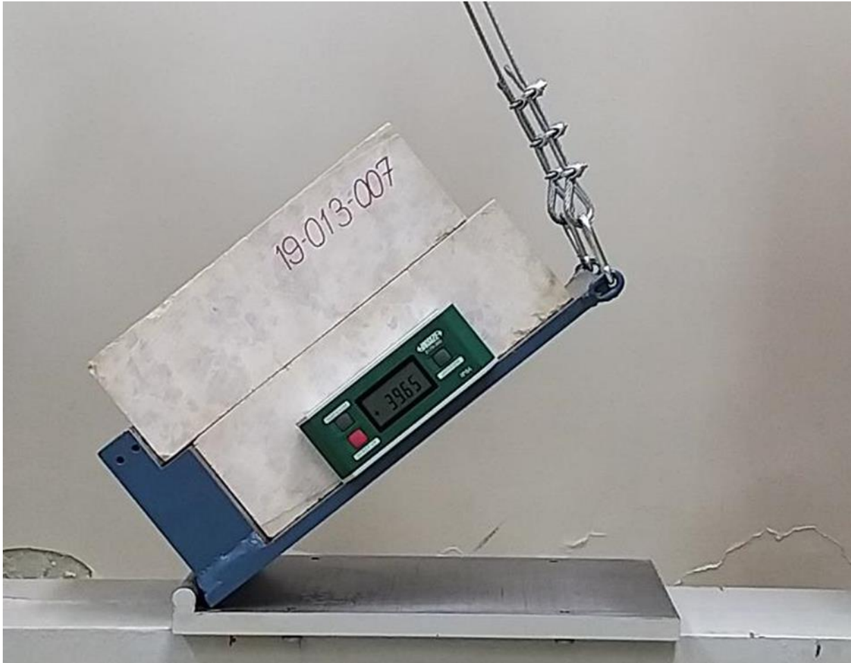
Slika 4-3. Priručni uređaj za pokus klizanja naginjanjem u Geomehničkom laboratoriju na RGNF-u
