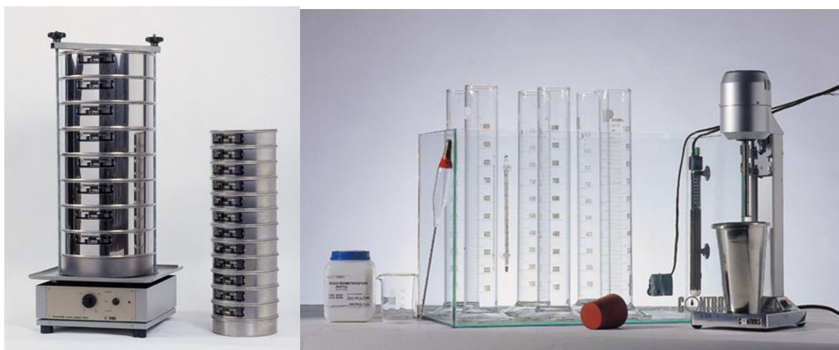
Slika 4-16. Oprema za granulometrijsku analizu (preuzeto s https://www.controls-group.com )
