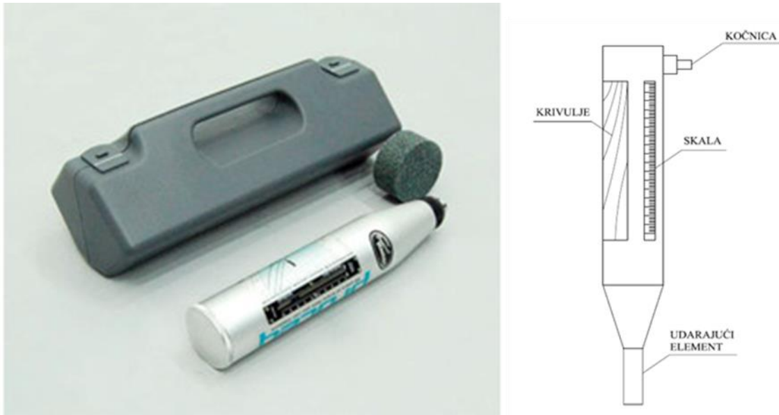
Slika 4-6. Schmidtov čekić (lijevi dio slike preuzet sa stranice https://www.controls-group.com )
