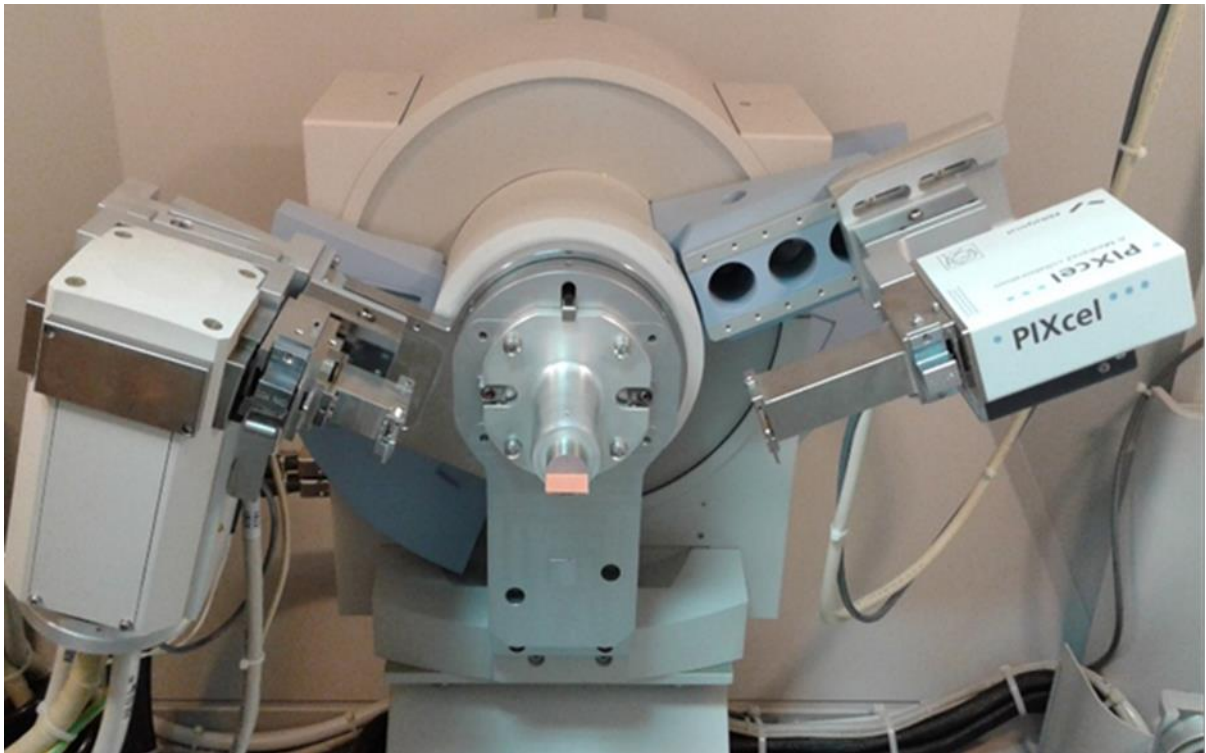
Slika 4-18. Rendgenski difraktometar Hrvatskog geološkog instituta
