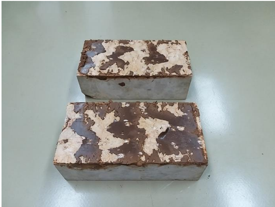
Slika 4-26. Izgled ispune u stanju CH4 nakon ispitivanja u uređaju za izravni posmik
