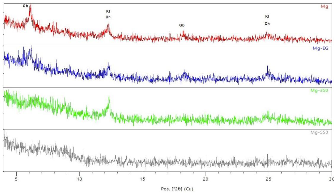
**Slika 7** Difrakcijska slika orijentiranog magnezijem saturiranog uzorka frakcije manje od 2  $\mu\text{m}$  nakon tretmana sušenja na zraku (Mg), naparivanja etilen glikolom (Mg-EG), žarenja na 350°C (Mg-350) i žarenja na 550°C (Mg-550). Ch – klorit, Gb – gibbsit, Kl – kaolinit
