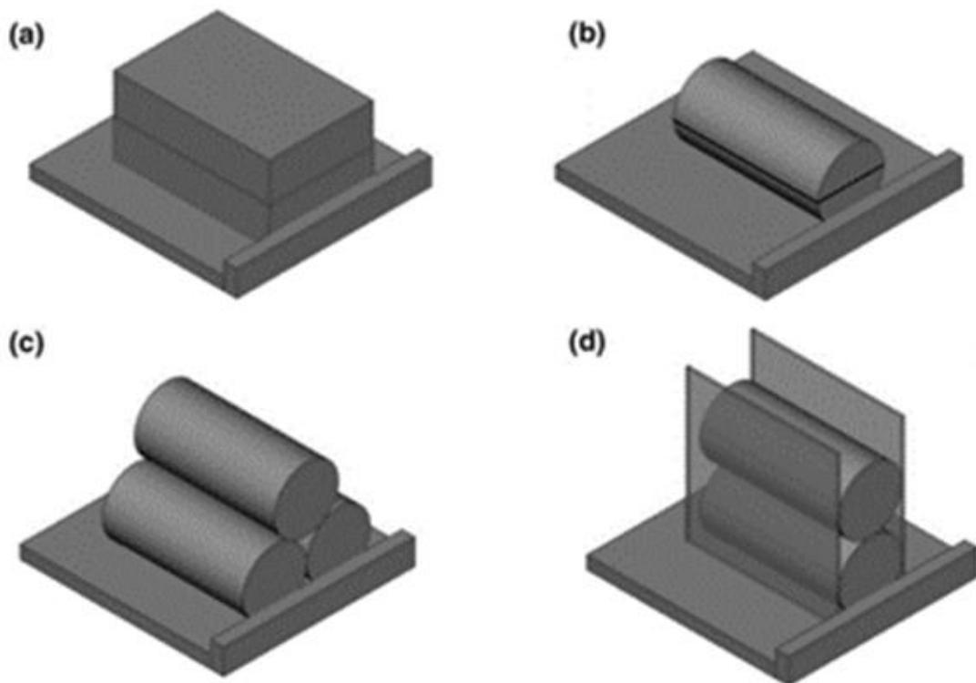
**Slika 4-1.** Mogućnosti određivanja bazonog kuta trenja pokusom klizanja naginjanjem
