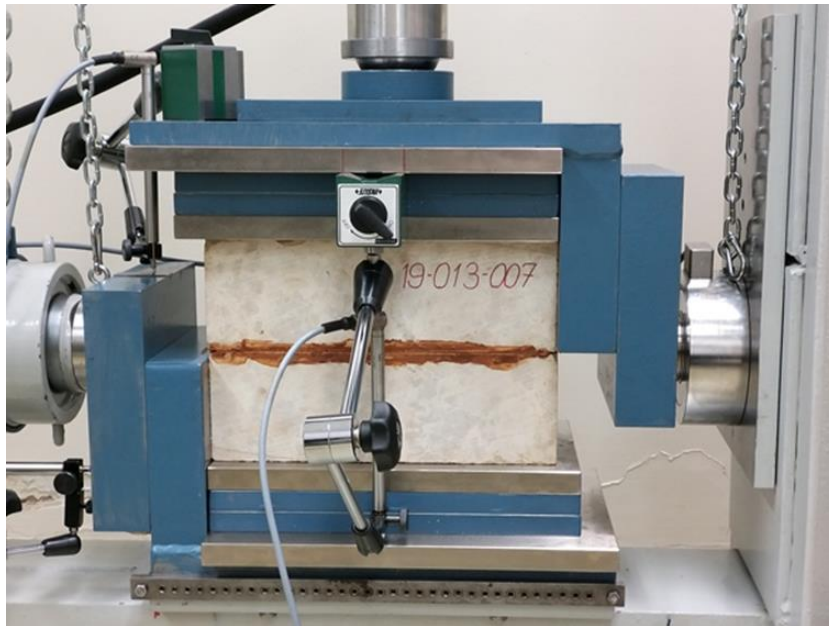
Slika 4-24. Ispitivanja kuta trenja s ugrađenom ispunom u uređaju za izravni posmik
