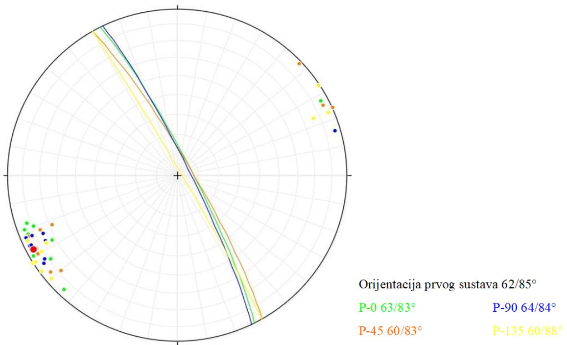
**Slika 3-10.** Strukturni dijagram prosječnih orijentacija po kutu mjerena i pripadajućih polova za prvi sustav diskontinuiteta
