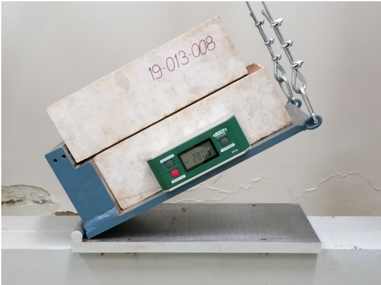
Slika 4-22. Pokus klizanja naginjanjem
