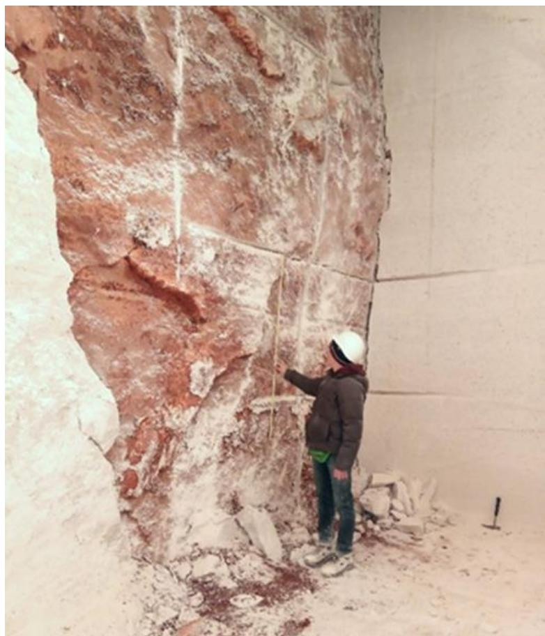
**Slika 3-3. Mjerenje amplitude hrapavosti**
