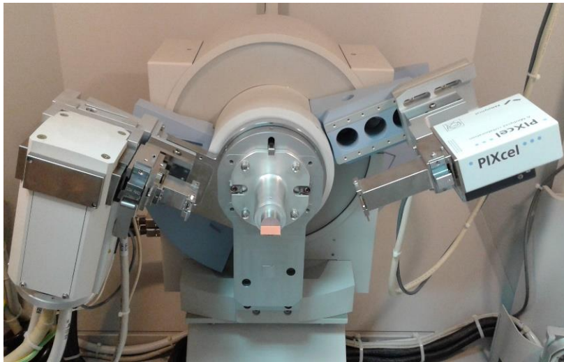
Slika 1 Rendgenski difraktometar Hrvatskog geološkog instituta s vertikalnim \theta - \theta goniometrom, keramičkom rendgenskom Cu-cijevi, PiXcel-ovim detektorom i odgovarajućim nosačima za uzorke (na slici je vidljiv nosač za orijentirane uzorke). Prilikom snimanja uzorak miruje, dok rendgenska cijev i detektor rotiraju oko uzorka.
