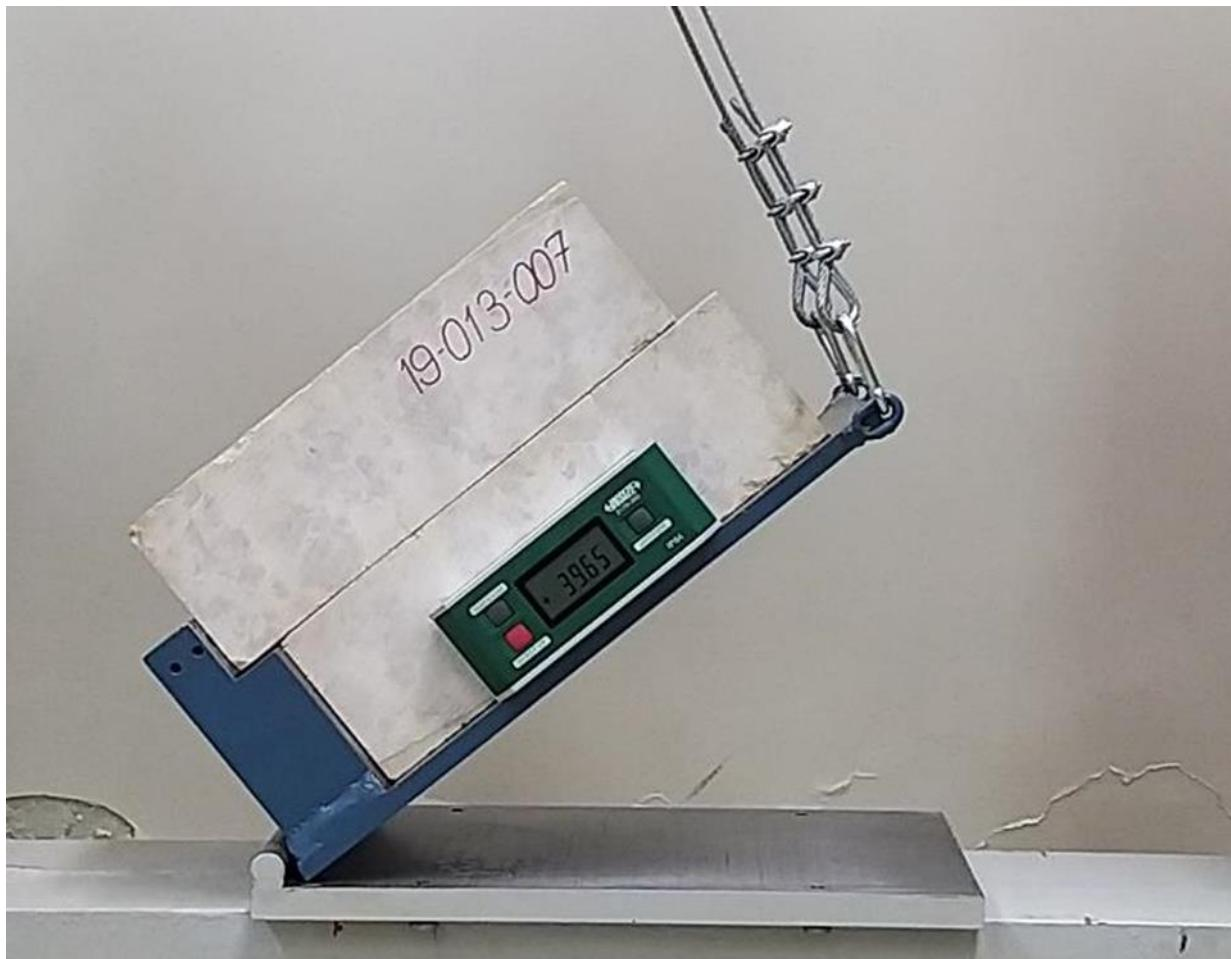
**Slika 4-3.** Priručni uređaj za pokus klizanja naginjanjem u Geomehaničkom laboratoriju na RGNF-u
