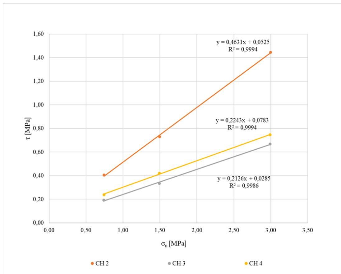
Slika 4-25. Rezultati mjerjenja kuta trenja s ugrađenom ispunom u uređaju za izravni posmik
