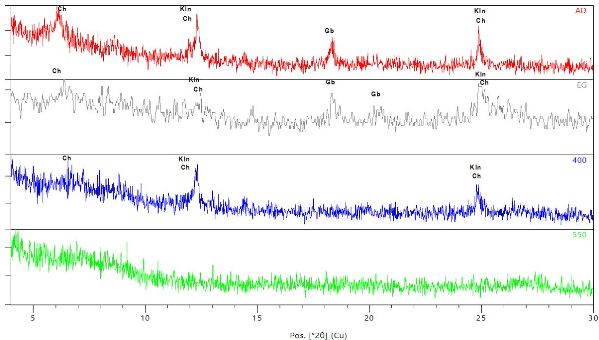
**Slika 5** Difrakcijska slika orientiranog uzorka frakcije manje od 2  $\mu\text{m}$  nakon tretmana sušenja na zraku (AD), saturacije etilen glikolom (EG), žarenja na 400°C i žarenja na 550°C. *Ch* – klorit, *Gb* – gibbsit, *Kln* - kaolinit
