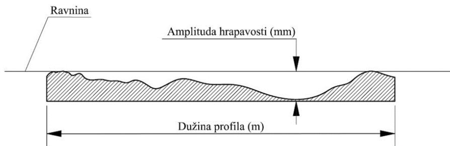
**Slika 2-7.** Određivanje amplitude hrapavosti (Barton i Bandis, 1982)
