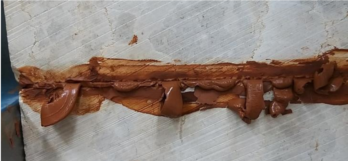
Slika 4-28. Istiskivanje ispune na granici tečenja
