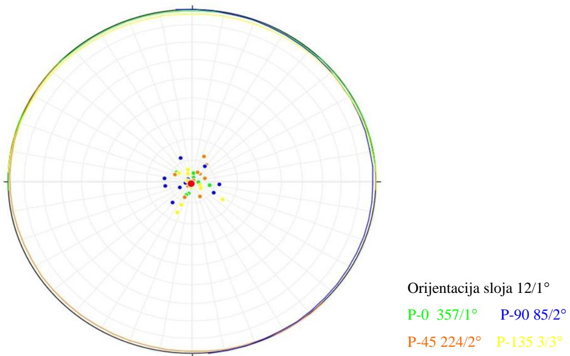
**Slika 3-8.** Strukturni dijagram prosječnih orijentacija po kutu mjerena i pripadajućih polova za slojnu plohu
