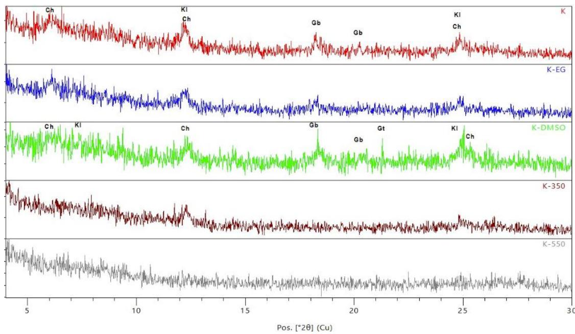
**Slika 6** Difrakcijska slika orijentiranog i kalijem saturiranog uzorka frakcije manje od 2  $\mu\text{m}$  nakon tretmana sušenja na zraku (K), naparivanja etilen glikolom (K-EG), solvatacije s DMSO (K-DMSO), žarenja na 350°C (K-350) i žarenja na 550°C (K-550). Ch – klorit, Gb – gibbsit, Kln - klorit
