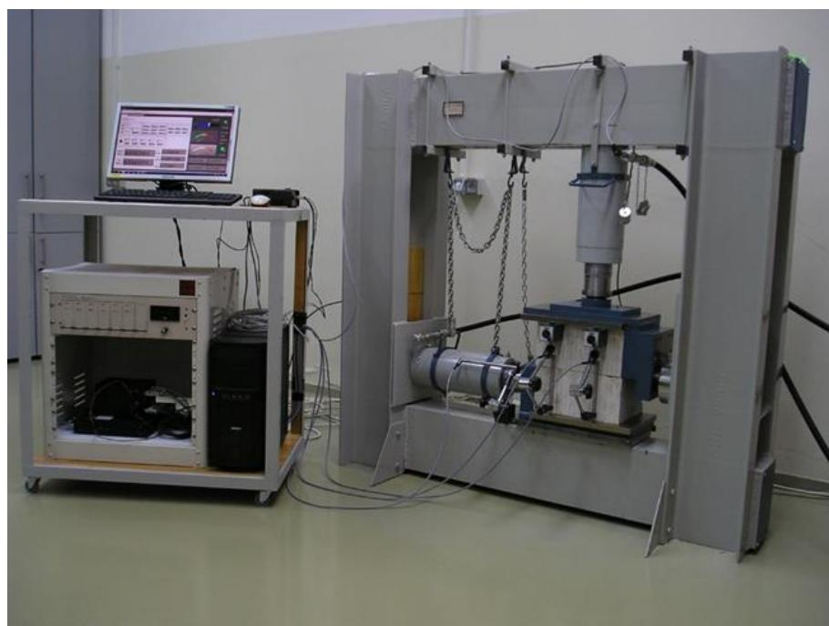
**Slika 4-27. Uređaj za izravni posmik velikih uzoraka**
