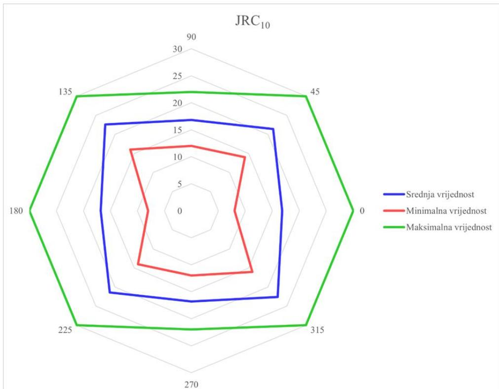
**Slika 3-11.** Dijagram raspodjela vrijednosti JRC<sub>10</sub> za prvi sustav diskontinuiteta
