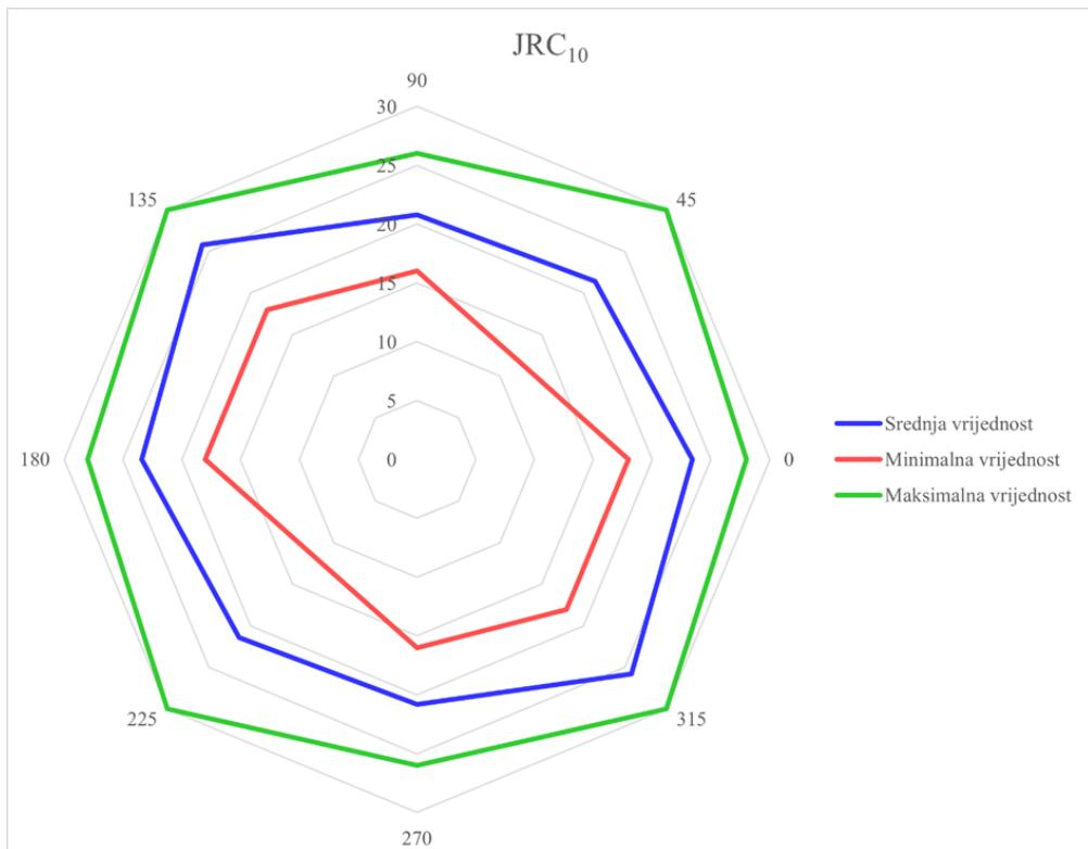
**Slika 3-9.** Dijagram raspodjela vrijednosti JRC<sub>10</sub> za slojnu plohu
