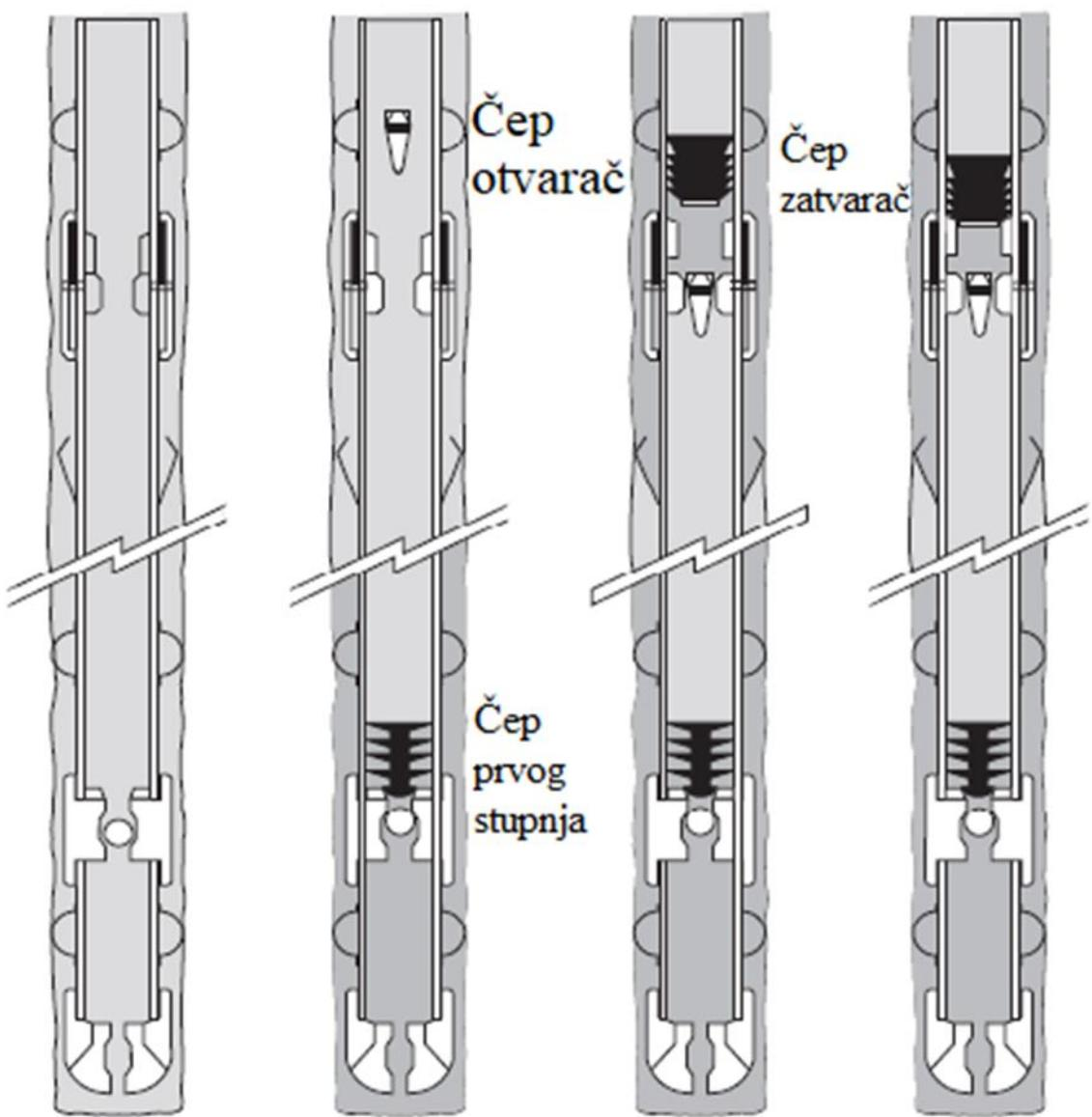
**Slika 4-6.** Shematski prikaz dvostupanjske cementacije s jednim čepom za protiskivanje kaše prvog stupnja (Bett, 2017)
