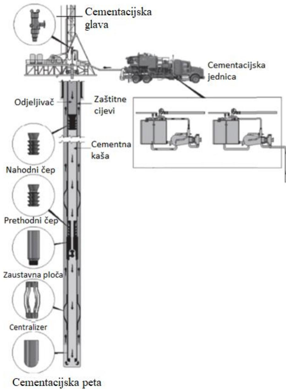
**Slika 4-1.** Shematski prikaz opreme kolone zaštitnih cijevi i procesa jednostupanjske cementacije (Bett, 2017)
