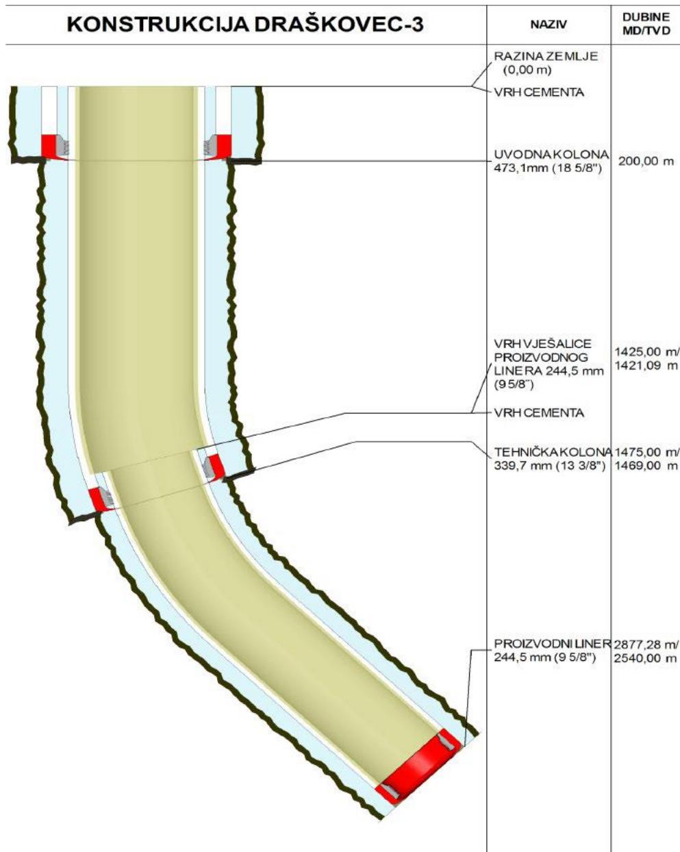
**Slika 7-5.** Konstrukcija bušotine Draškovec-3 (Hrgalek et al., 2017)
