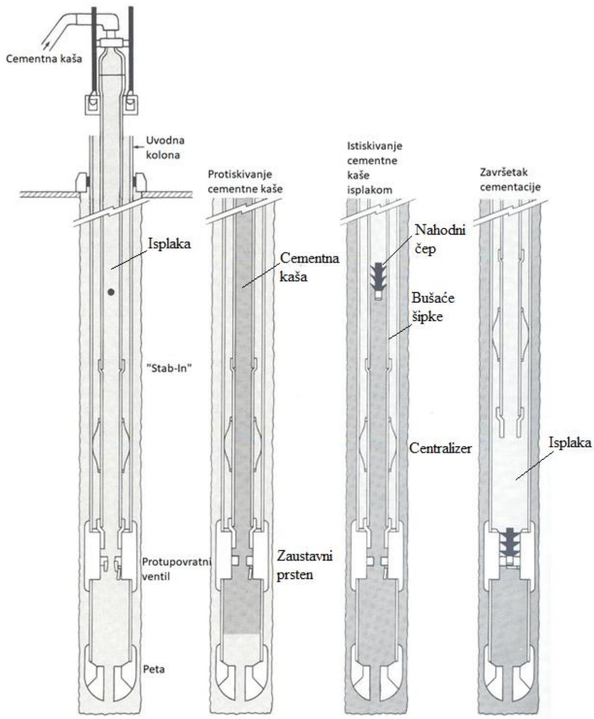
**Slika 4-3.** Shematski prikaz cementacije uvodne kolone zaštitnih cijevi kroz bušaće šipke (Bett, 2017)
