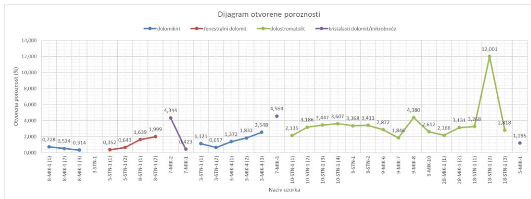
Slika 4-1. Dijagram otvorene poroznosti uzoraka mjerjenih metodom uronjene mase (Pavičić, 2018).
