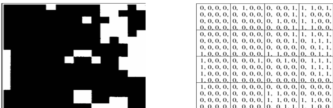
Slika 3-3. Binarna fotografija i matrica slike: 0-crna boja; 1-bijela boja (Jie et al., 2007).
