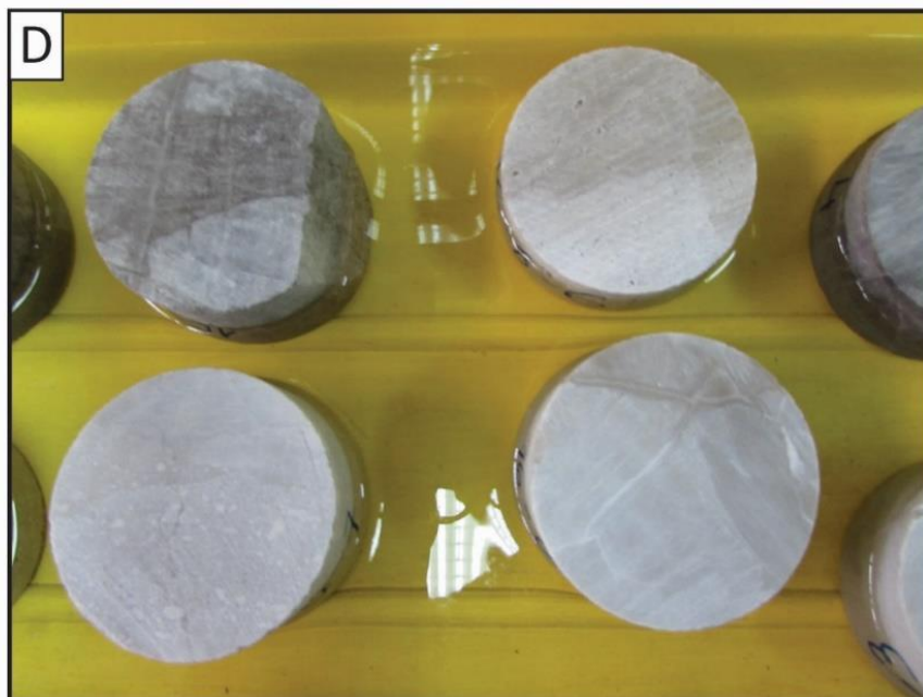
Slika 3-1. A i B) Fotografije uzoraka pravilnog oblika; C i D) uzorci za vrijeme saturacije vodom (iz Pavičić 2018).
