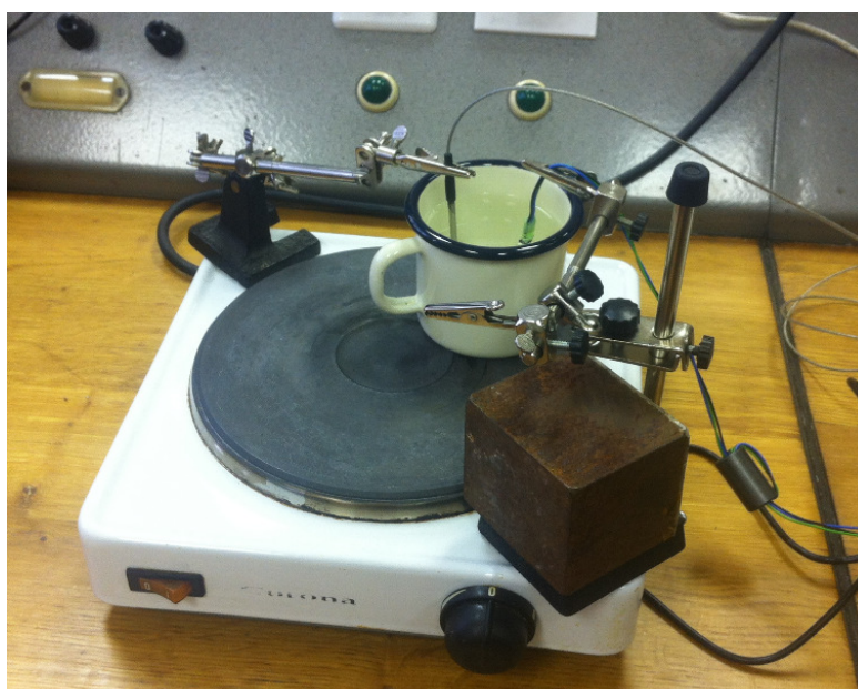
Slika 5-13. Umjeravanje senzora na temperaturi od 90^\circ \text{C}
