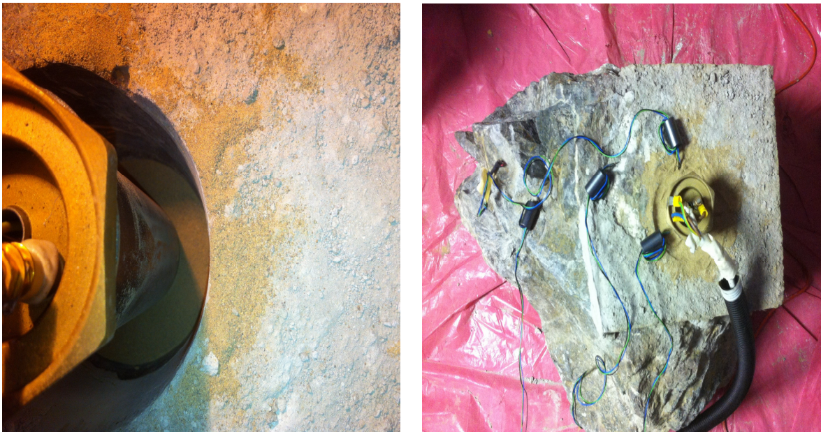
Slika 5-8. Dodavanje bentonitne ispune
