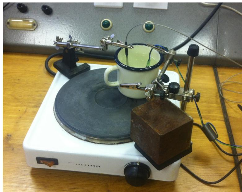
Slika 5-13. Umjeravanje senzora na temperaturi od  $90^\circ \text{C}$
