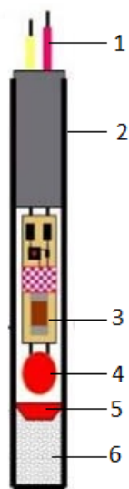
Slika 2-13 Prikaz elektroničkog detonatora(Rock Products News, 2021)
