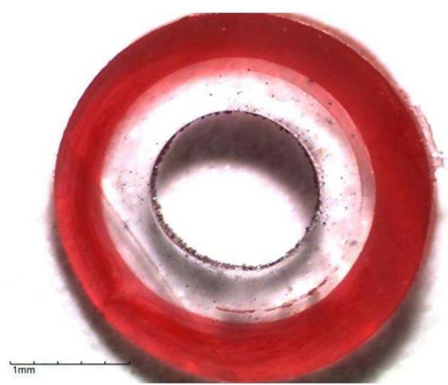
Slika 2-11 Poprečni presjek udarne cjevčice (Fabien, 2017)
