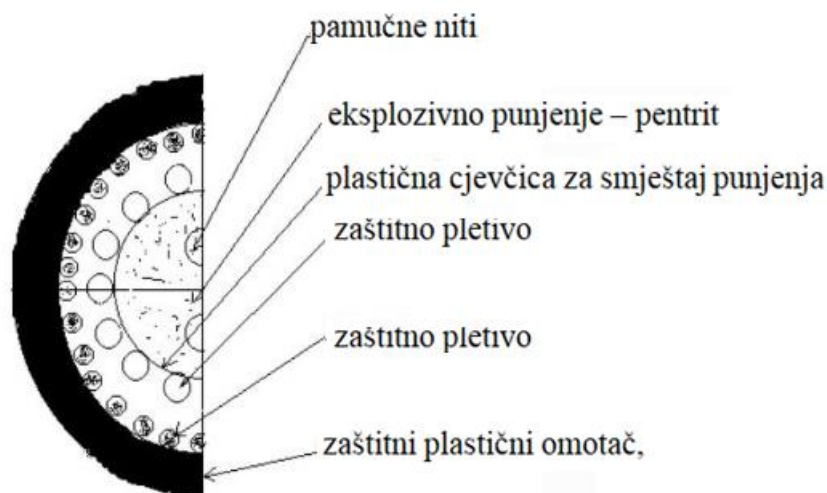
Slika 2-5 Presjek detonirajućeg štapina (Sharma, 2008)
