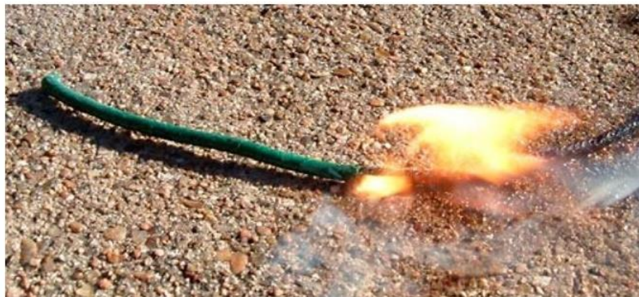
Slika 2-1 Prikaz sporogorećeg štapina (Ehardt, 2008)
