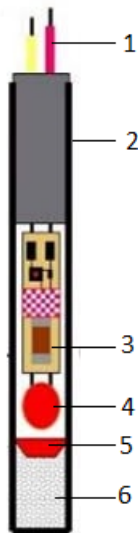
Slika 2-13 Prikaz elektroničkog detonatora(Rock Products News, 2021)
