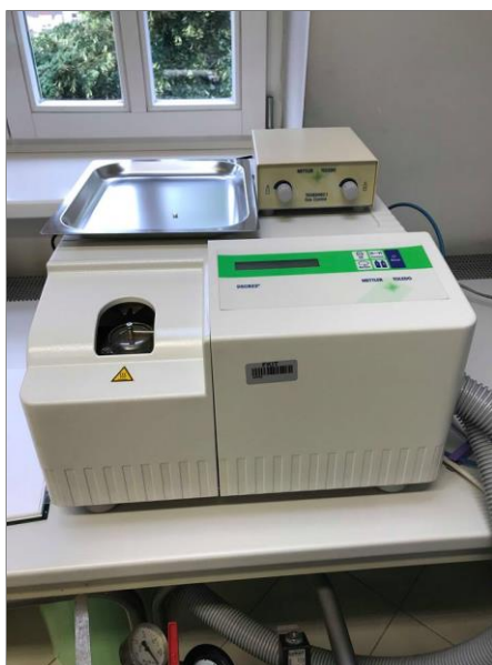
Slika 32. Diferencijski pretražni kalorimetar, Mettler Toledo DSC 823e
