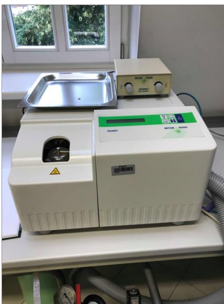
Slika 32. Diferencijski pretražni kalorimetar, Mettler Toledo DSC 823e
