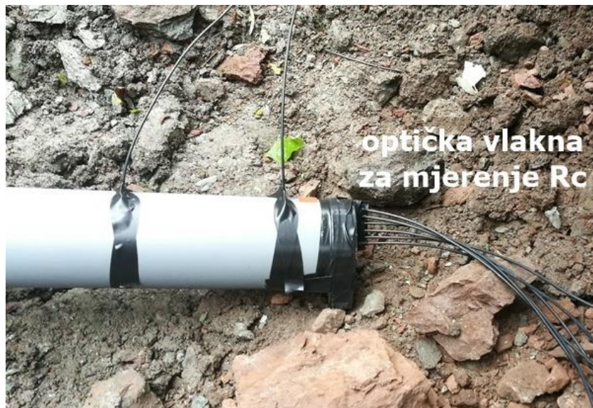
Slika 49. Primjer postava za određivanje radijusa zakrivljenosti fronte detonacijskog vala u terenskim uvjetima
