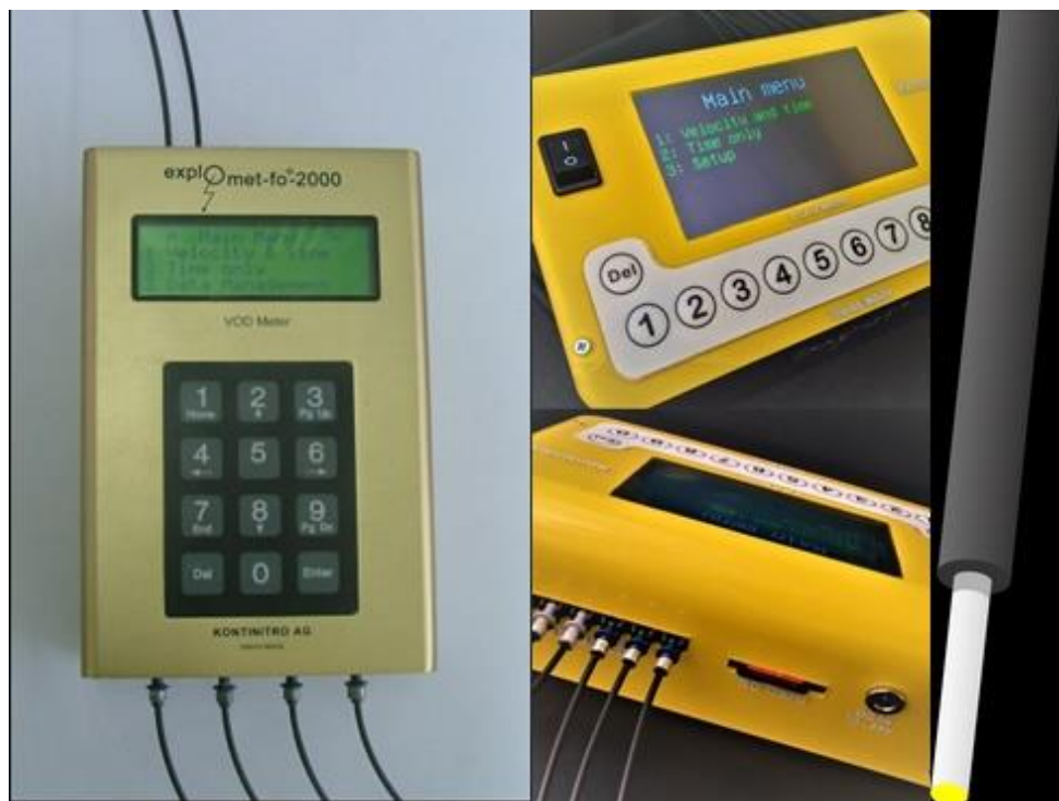
Slika 31. Explomet-Fo-2000 (lijevo); Explomet 2 (sredina); optičko vlakno (desno)
