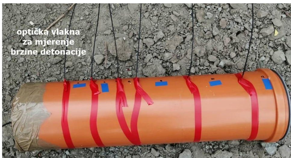
Slika 36. Primjer postava za mjerenje brzine detonacije u terenskim uvjetima
