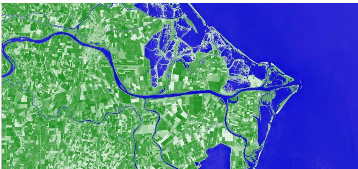
Slika 5-4 Prikaz vrijednosti NDWI pri čemu su zelenom bojom označena vegetacija i tlo, dok su plavom bojom označene vodene površine. (Custom-script, 2021.)
