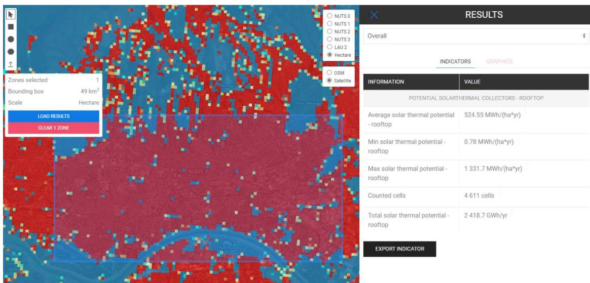
**Slika 5-3.** Potencijal proizvodnje toplinske energije solarnim kolektorima za odabranu područje (Hotmaps, 2020.)
