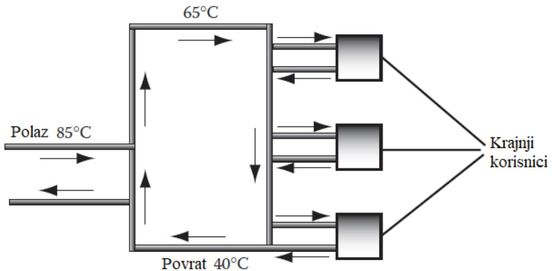
**Slika 3-2.** Shema CTS - a s izravnom proizvodnjom geotermalnog fluida u distribucijsku mrežu (Glassley, 2014)
