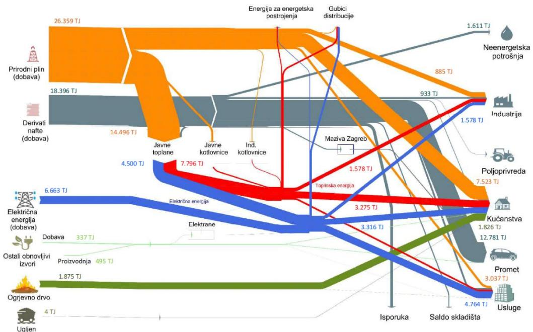
**Slika 5-4.** Shematski prikaz energetskog toka Grada Zagreba za 2018. godinu (Energetski institut Hrvoje Požar, 2019)
