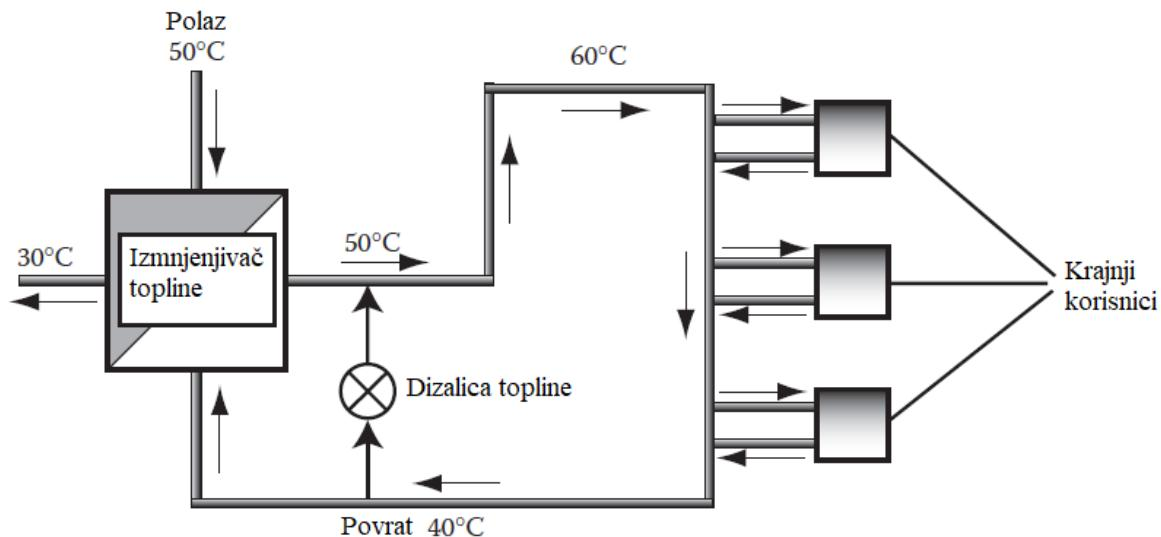
**Slika 3-4.** Shema geotermalnog CTS - a s primjenom dizalica topline (Glassley, 2014)
