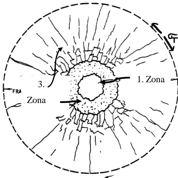
Slika 4-4 Zone djelovanja detonacije eksplozivnog naboja (Geoengineer, 2015)
