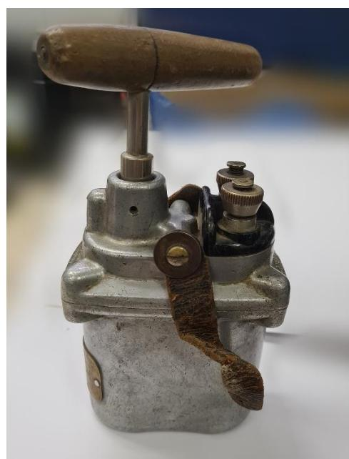
Slika 2-8 Dinamo električni stroj za paljenje električnih detonatora
