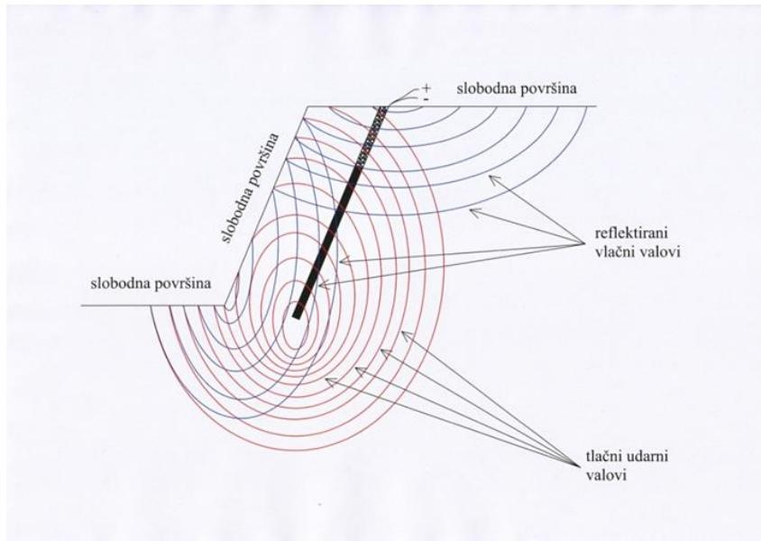
**Slika 4-5** Nastajanje tlačnih udarnih valova i reflektiranih vlačnih valova (Stanković, 2011.)
