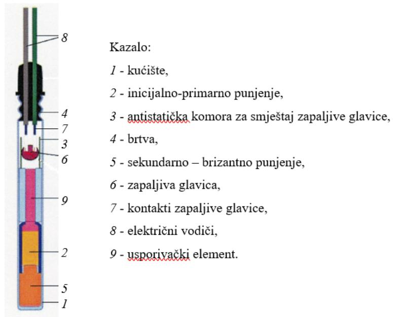
Slika 2-7 Električni detonator s kašnjnjem
