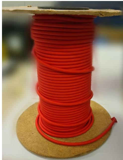
Slika 2-4 Detonirajući štapin
