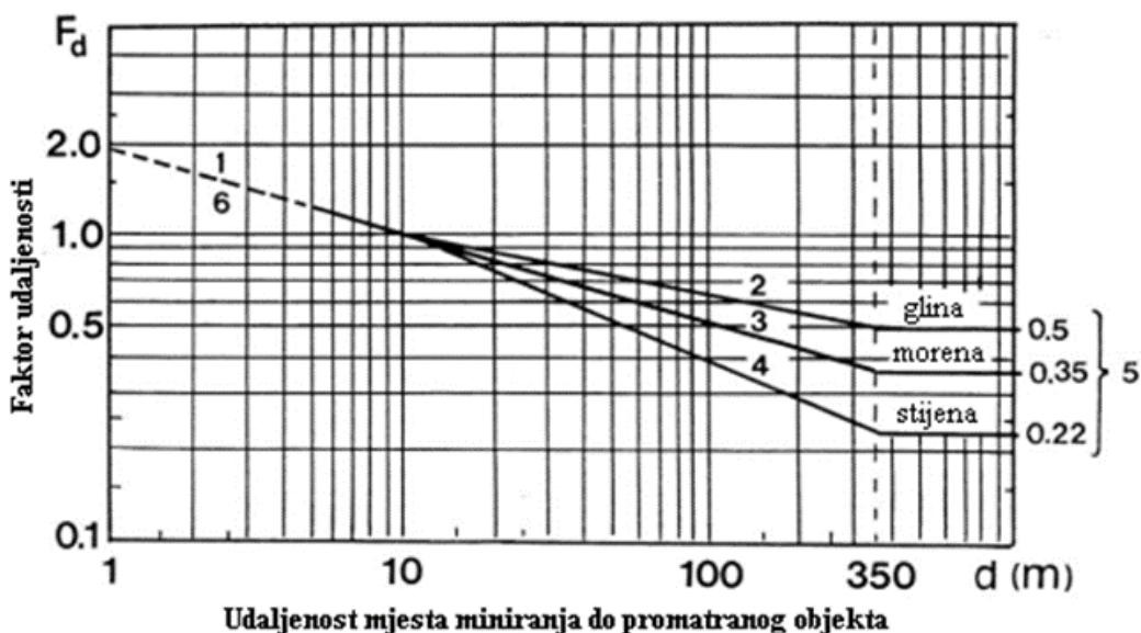
**Slika 4-6** Dijagram ovisnosti faktora udaljenosti  $F_d$  od udaljenosti mesta miniranja do promatranog objekta (Stanković, 2011.)
