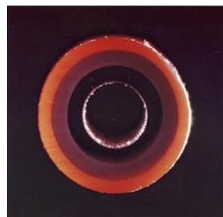
Slika 2-9 Poprečni presjek udarne cjevčice (Stanković, 2011.)
