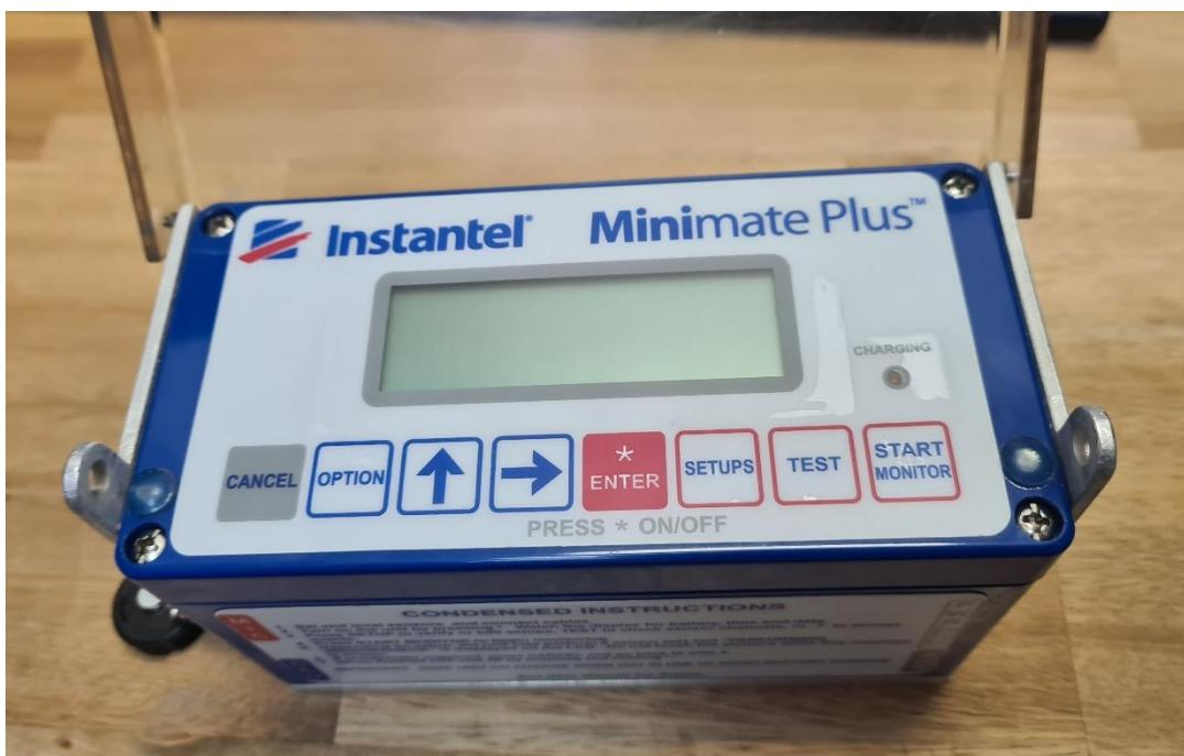
Slika 6-4 Instrument za mjerjenje brzina oscilacija tla Instantel Minimate Plus
