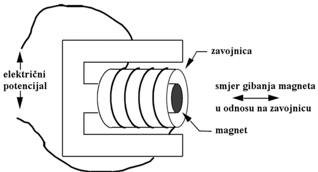
Slika 6-5 Načina rada geofona – (BlastMate III Operator Manual 2001.).
