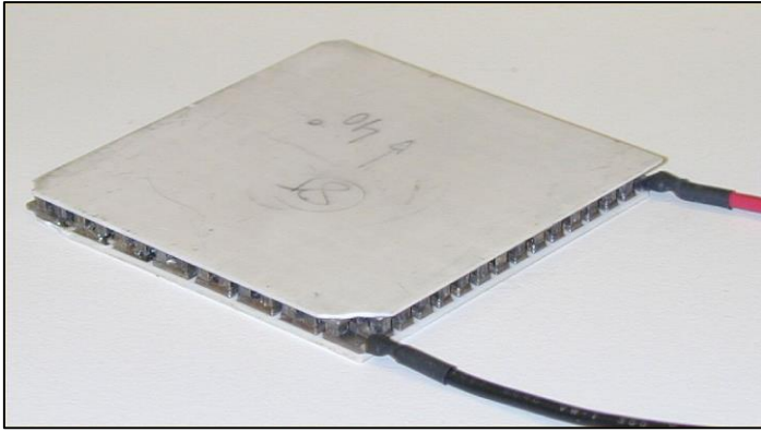
Slika 5-2. Termoelektrični generator Peltier (Wikipedia, 2021.)
