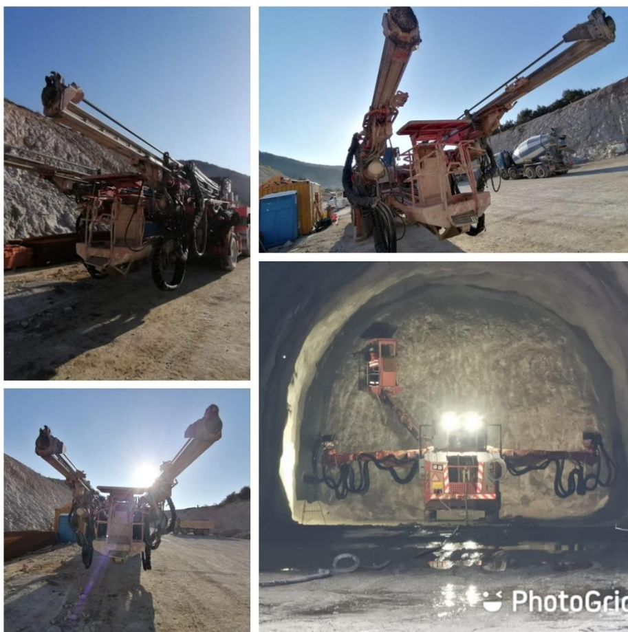
Slika 5.2-3 Jumbo tunelska bušilica „Sandvik DT820-SC“
