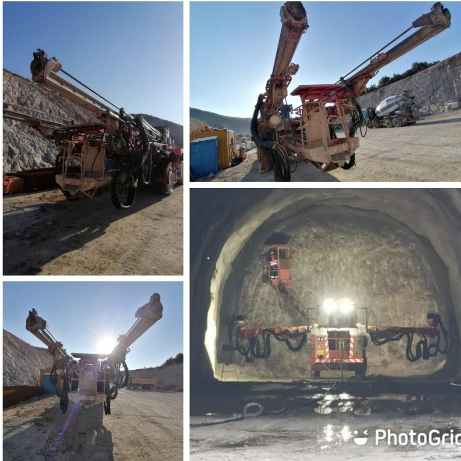
Slika 5.2-3 Jumbo tunelska bušilica „Sandvik DT820-SC“
