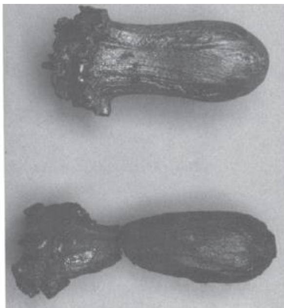
Slika 6-14 EFP od tantala. Gornji projektil: eksploziv sastava B. Donji projektil: Oktol (Weickert, 1998)
