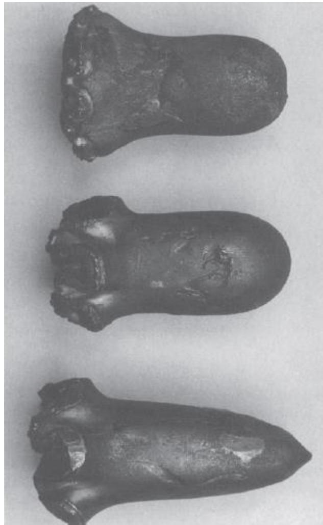
Slika 6-15 EFP stabilizirani otporom. Gornji projektil: rašireni rep. Srednji projektil: rep s perajama. Donji projektil: rep s perajama i šiljasti nos (Weickert, 1998)
