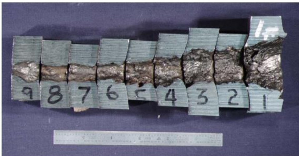
Slika 6-4 Poprečni presjek ciljnog bloka koji prikazuje dobiveni profil prodora kumulativnog naboja (William P. Walters, 2006)
