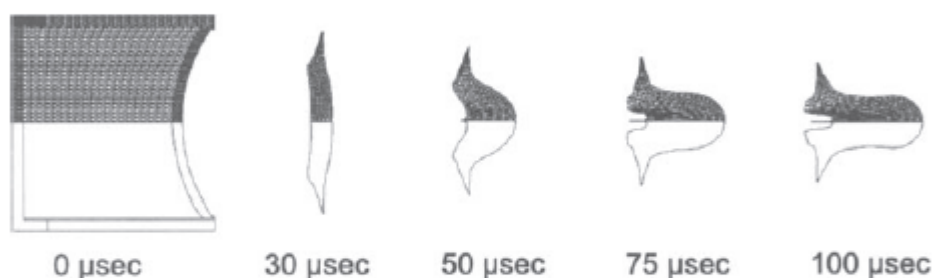
Simulacija preklapanja ruba obloge prema natrag
