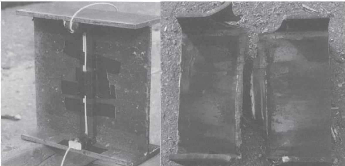
Slika 6-30 C-4 eksploziv pričvršćen na čeličnu gredu (slika lijevo) i prikaz štete koju je eksploziv napravio (slika desno) (Weickert, 1998)
