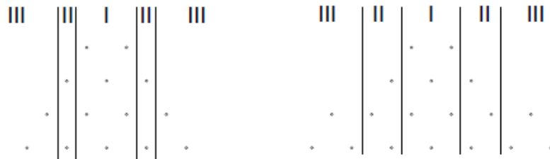
Slika 8-5 Redoslijed otpucavanja minskih bušotina
