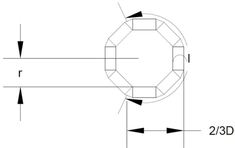
Slika 10-6 Poprečni presjek ciglenog dimnjaka sa zalomom 2/3 opsega
