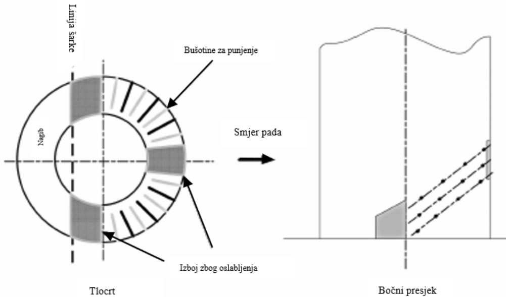
Slika 5-2 Najboli način pripreme betonskog dimnjaka za rušenje (Rushforth i Faulkner,2017 )
