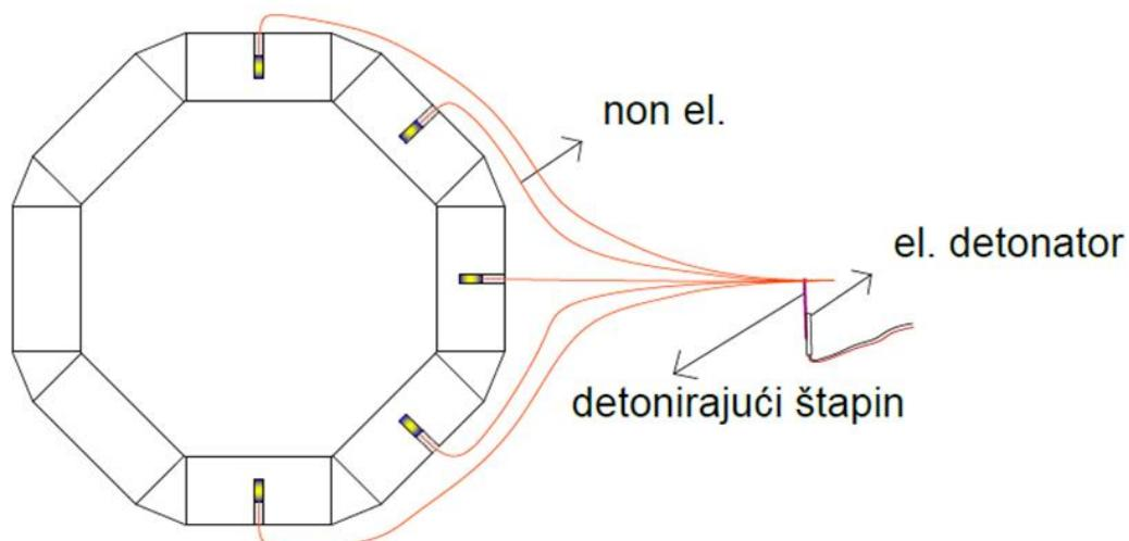
Slika 10-8 Raspored minskih bušotina kod ciglenog dimnjaka sa zalomom  $\frac{1}{2}$  opsega
