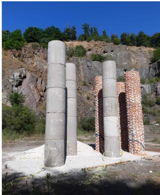
**Slika 8-4** Prikaz betonskih i ciglenih dimnjaka na terenu
