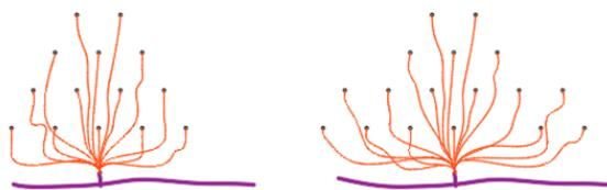
Slika 8-7 Shema povezivanja minskih bušotina – neelektrični sustav iniciranja
