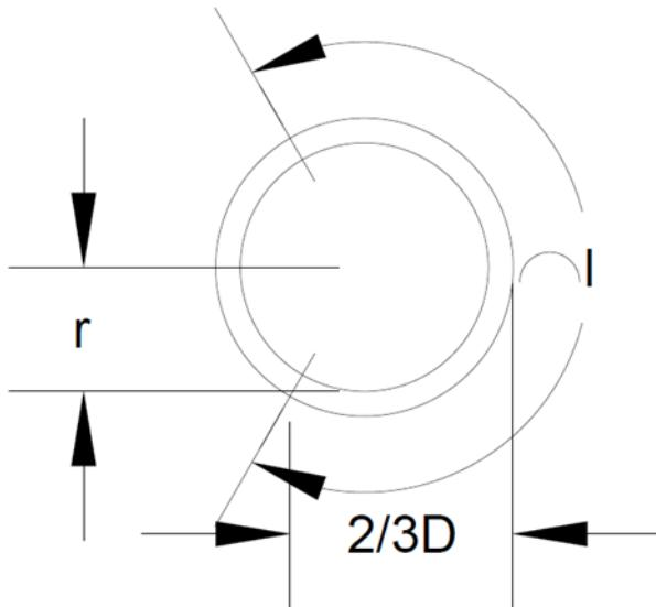
Slika 10-2 Poprečni presjek betonskog dimnjaka sa zalomom 2/3 opsega
