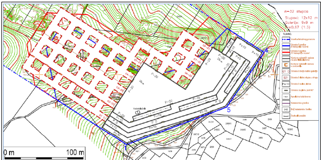
Slika 3-8. Završno stanje razvoja podzemnog kopa u drugoj varijanti (Galić i dr., 2020.)
