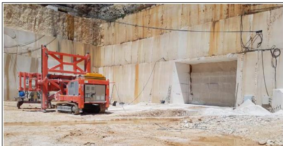
Slika 4-17. Otvaranje i razvoj galerije specijaliziranom sjekačicom dosega 8,8 m širine (Kamen Pazin d.d.–Kanfanar)
