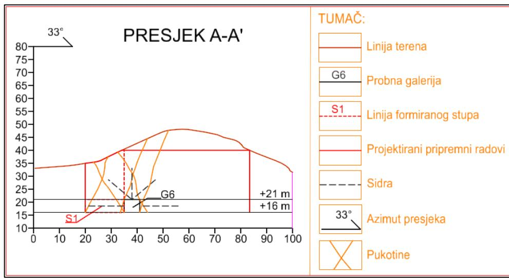
**Slika 4-18.** Shema sidrenja na vertikalnom presjeku A–A' za probnu podzemnu eksploraciju na +16 m
