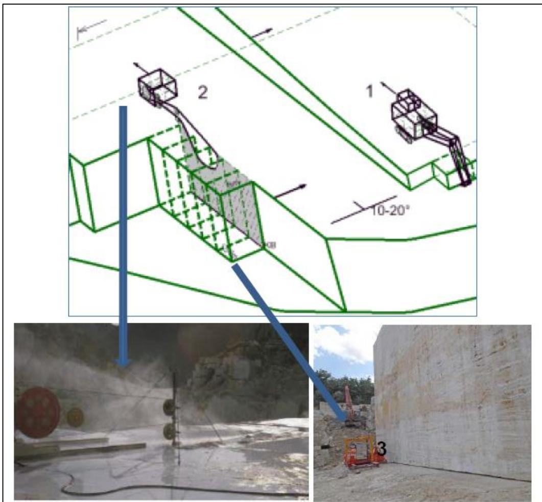
**Slika 4-8.** Shematski i foto prikaz dobivanja blokova sjekačicom i dijamantnom žičnom pilom (1–bager; 2–dijamantna žična, vertikalni rezovi pila; 3–lančana sjekačica L=3–4 m, horizontalan rez) (Galić i dr., 2020.)
