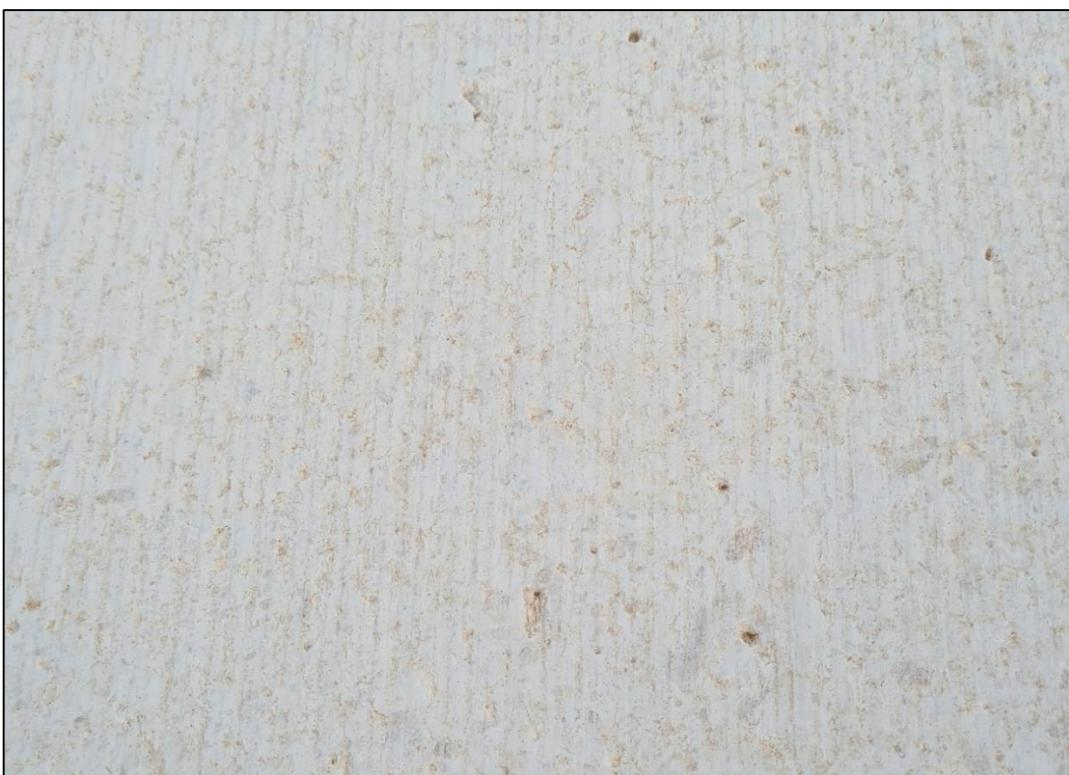
**Slika 4-10.** Izgled reza lančane sjekačice (Kamen Pazin d.d.–Plano)
