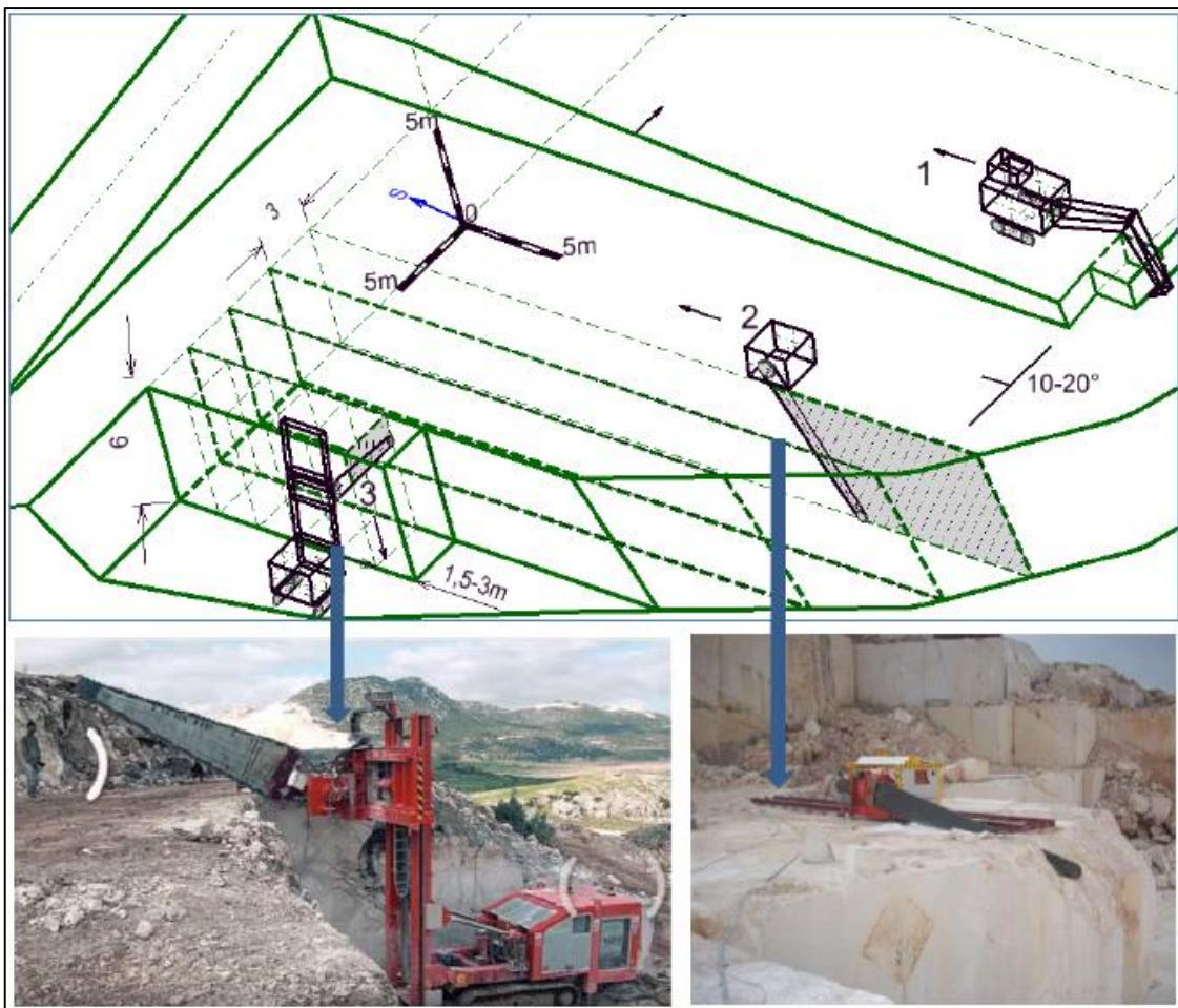
**Slika 4-7.** Shematski i foto prikaz dobivanja blokova kombinacijom lančanih sjekačica (1–bager; 2–lančana sjekačica L=8 m, uzdužni vertikalni rez; 3–lančana sjekačica L=4 m, poprečni vertikalni rez) (Galić i dr., 2020.)
