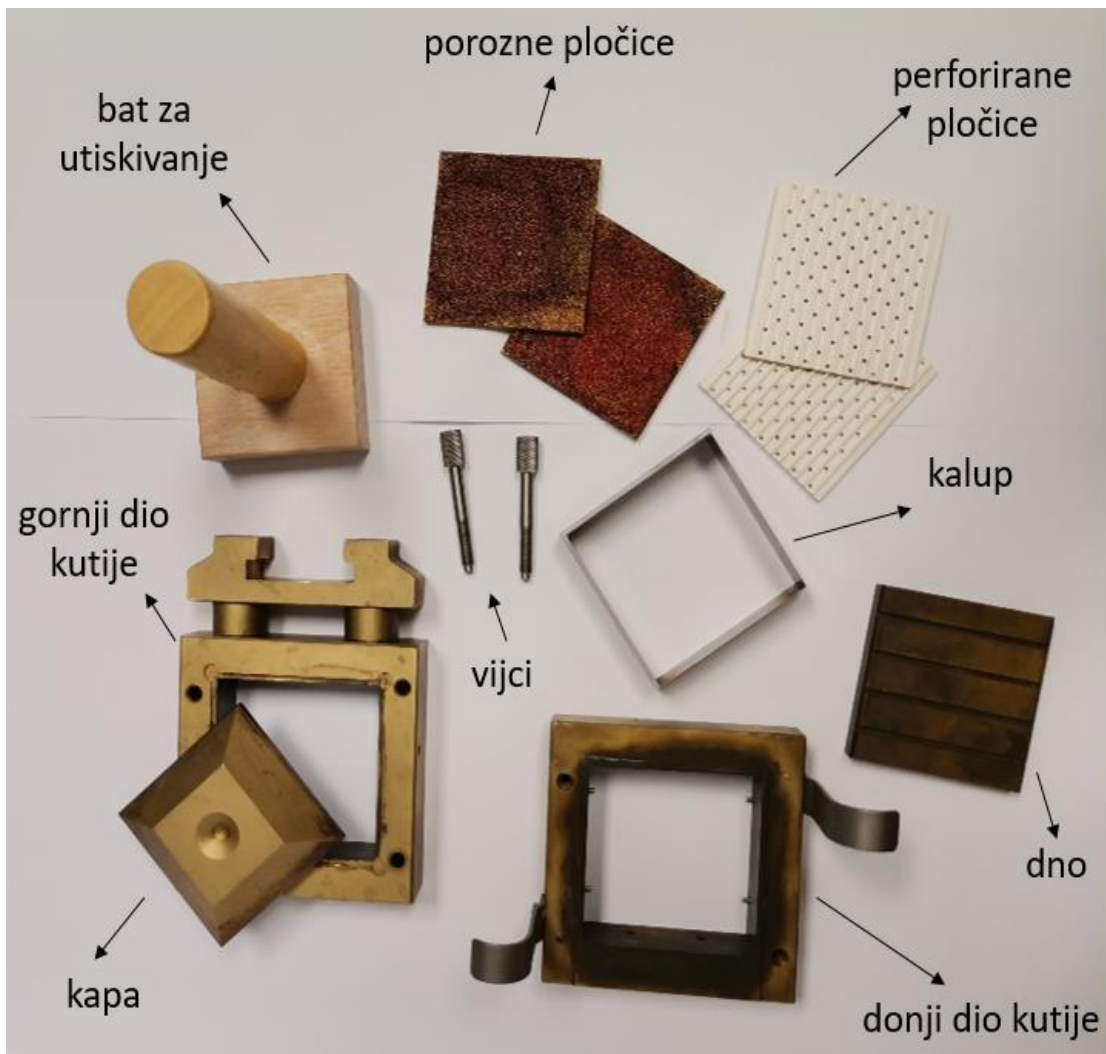
Slika 4-9 Dijelovi uređaja za smicanje
