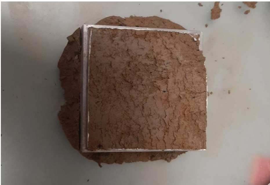
Slika 4-11 Utiskivanje uzorka u kalup
