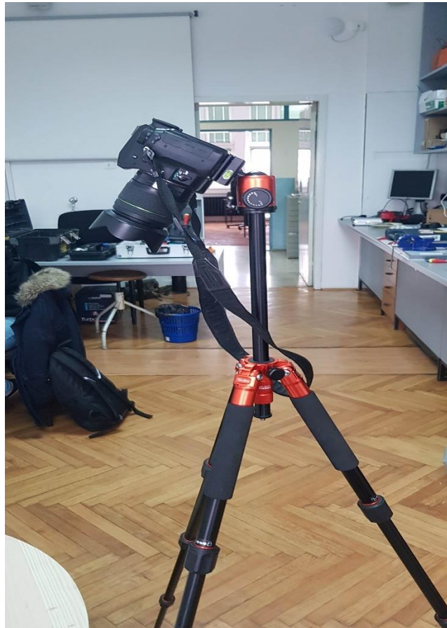
Slika 4-7 Položaj kamere pod kutem od 60°
