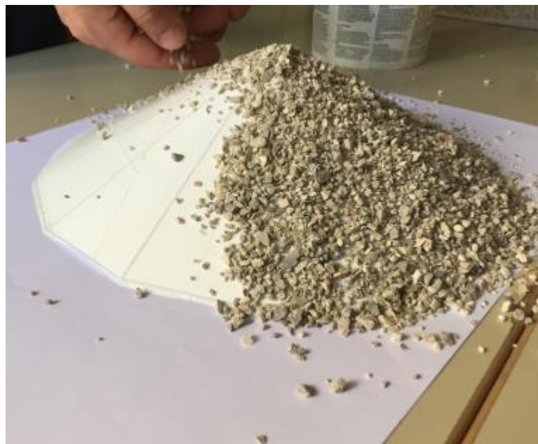
Slika 4-4 Posipanje granuliranog materijala na plašt stošca (Kostrić, 2018)
