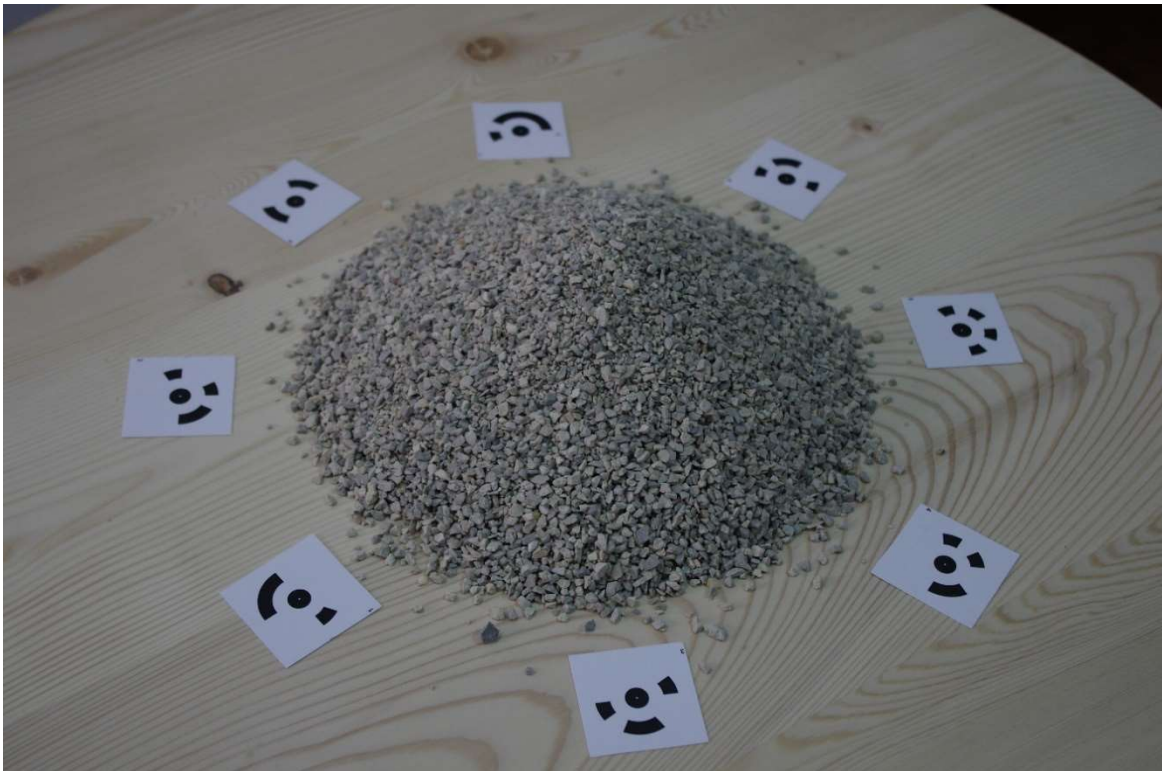
Slika 4-3 Tehničko-građevni kamen korišten za ispitivanje
