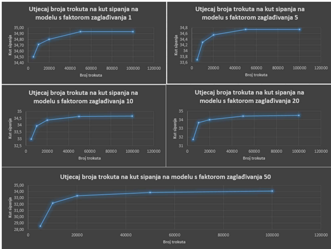
Slika 5-3 Utjecaj broja trokuta na kut sipanja na modelima s faktorom zaglađivanja 1, 5, 10, 20 i 50 (realna hrpa)
