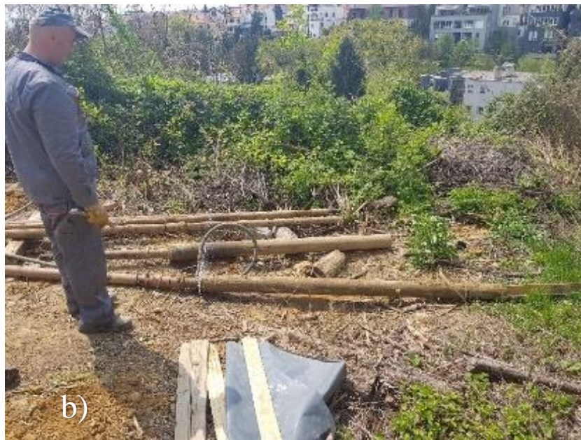
Slika 3.2.2. a) Sanduk s prvih 5 metara jezgre bušotine B-3 i čeličnim cilindrom koji sadrži neporemećeni uzorak. b) Vađenje jezgre iz jezgrene cijevi vodom pod tlakom.
