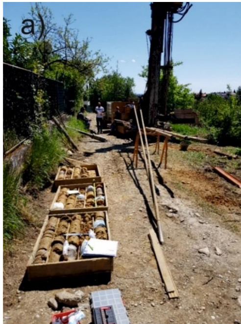
Slika 3.3.1. a) Istražno bušenje i determinacija jezgre na bušotini B-1, b) Terenski obrazac za determinaciju i opisivanje jezgre.
