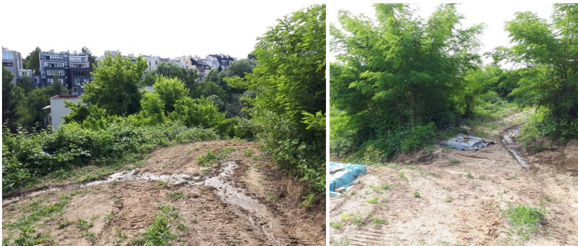
Slika 2.4.2. Pojava vlaženja terena i površinske vode između bušotina B-2 i B-3.
