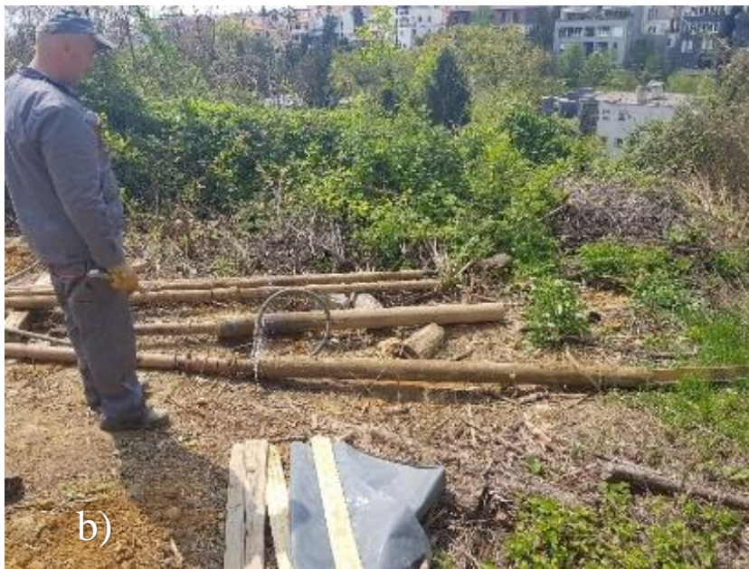
Slika 3.2.2. a) Sanduk s prvih 5 metara jezgre bušotine B-3 i čeličnim cilindrom koji sadrži neporemećeni uzorak. b) Vađenje jezgre iz jezgrene cijevi vodom pod tlakom.
