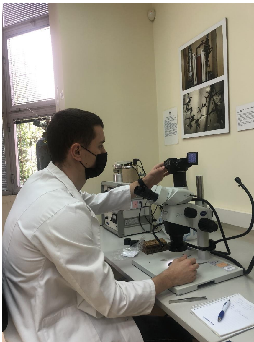
Slika 3-5. Pregledavanje uzoraka na stereomikroskopu Olympus SZX10
