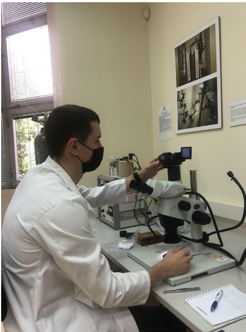
Slika 3-5. Pregledavanje uzoraka na stereomikroskopu Olympus SZX10
