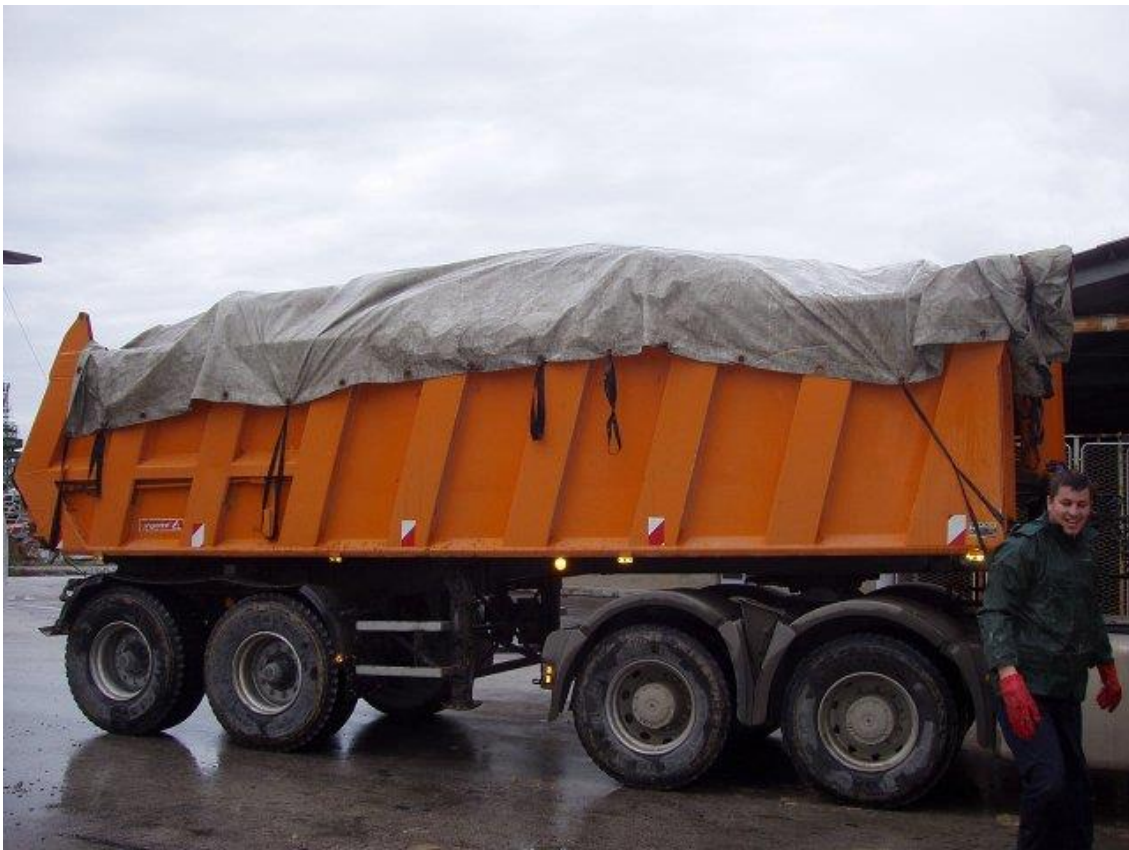
Slika 2-7. Pravilan transport azbestnog otpada (Cian d.o.o., 2020)
